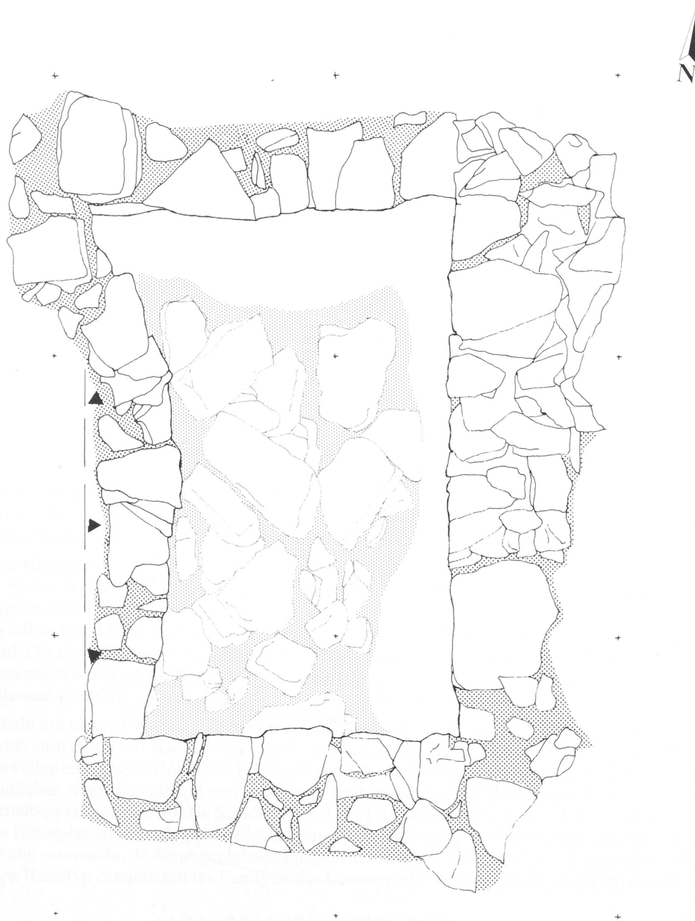
Abb. 4 Göttingen, Weender Str. 54. Aufsicht auf die Kloake mit Steinpackung, Rasterabstand 1 m.
