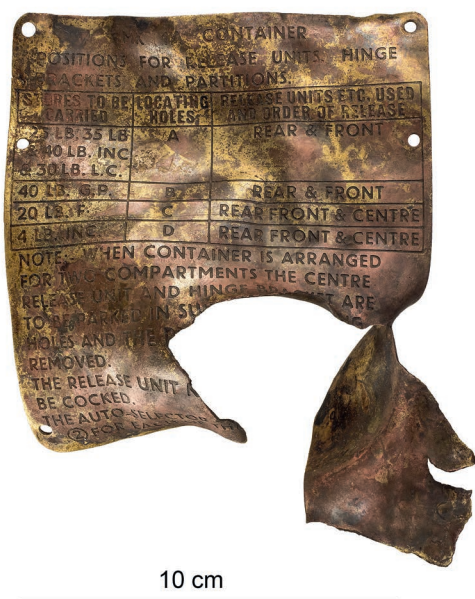
Abb. 145 Jesteburg FStNr. 86, Gde. Jesteburg, Ldkr. Harburg (Kat.Nr. 202). Beladungshinweisschild eines Bombencontainers Mk. 1A für Stabbrand- oder Phosphorbomben. M. 1:2. (Foto: T. Weise)
