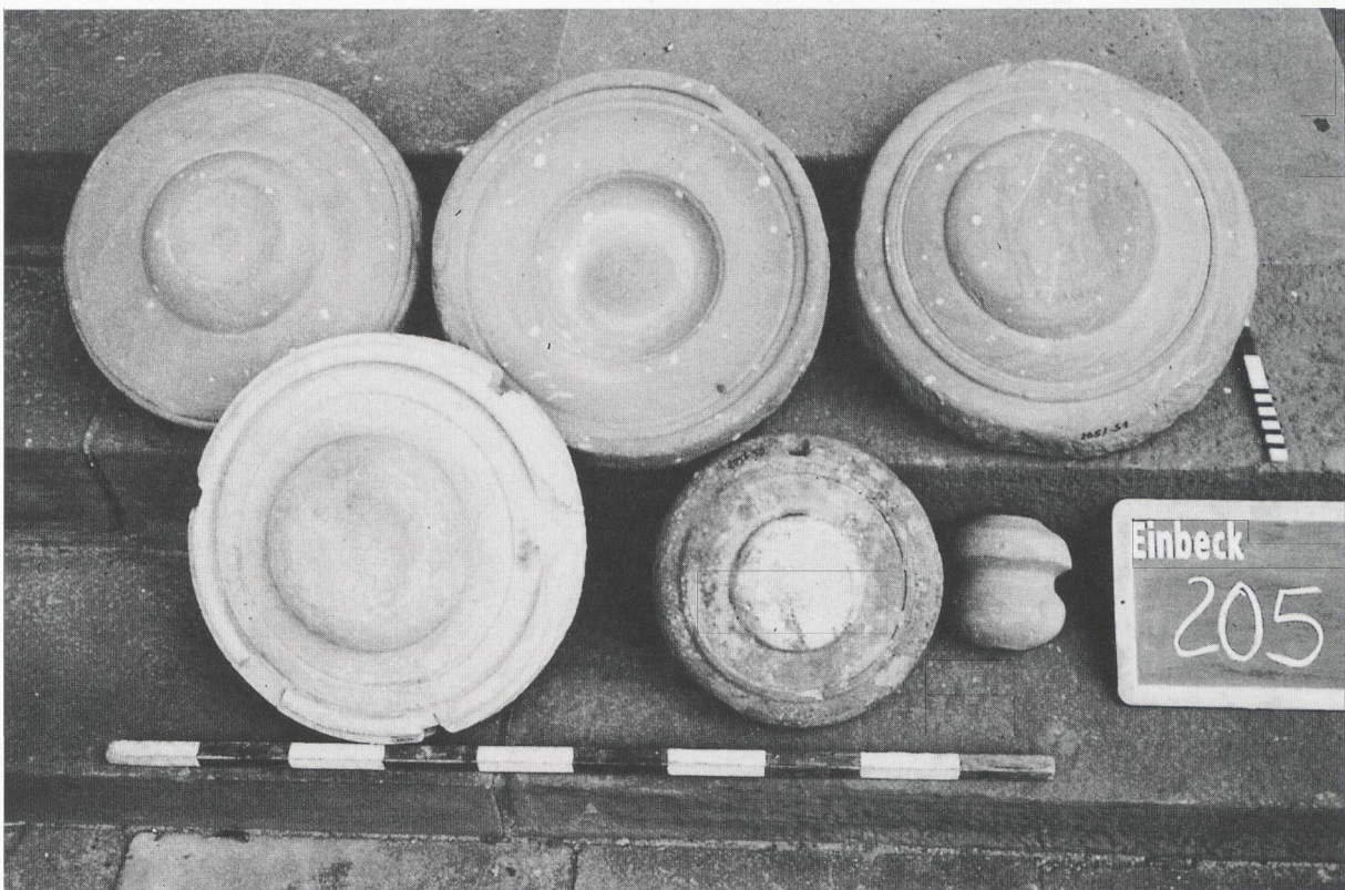
Abb. 155 Einbeck FStNr. 205, Gde. Stadt Einbeck, Ldkr. Northeim (Kat.Nr. 392) Gussformen aus Sandstein für Zinnteller. Die größte hat einen Durchmesser von 45 cm. Die Gussformen wurden in der 2. Hälfte des 18. Jh.s zusammen mit anderem Gesteinsmaterial zu Isolationszwecken im Keller einplaniert.
