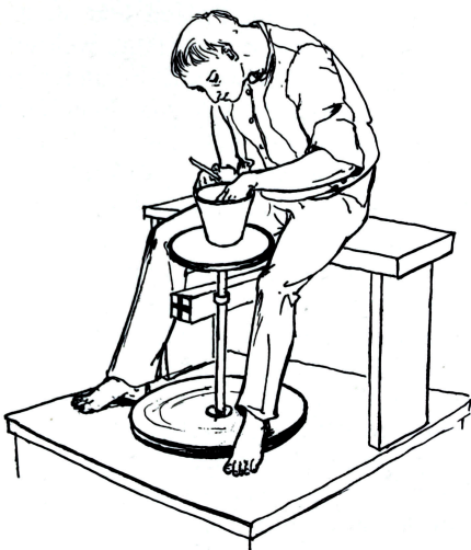
17 Abbildungsschema einer Drehscheibe mit Fußantrieb (Goebels 1985, 65).
