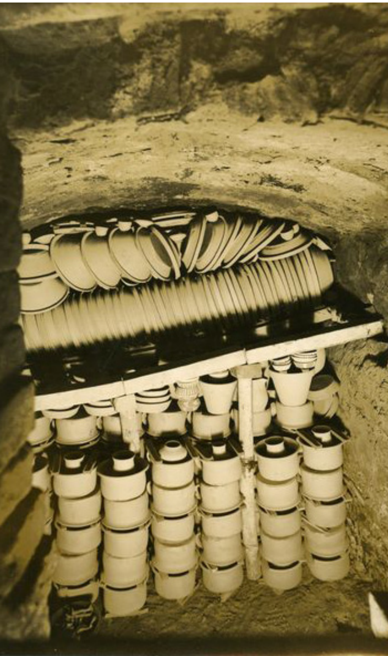
1 Blick durch die Beschickungsöffnung in einen Brennraum, der teilweise mit Stapeln von verschiedenen ungebrannten Warenarten gefüllt ist. Töpferbetrieb des Hafnermeisters Josef Maier in seinem Schweizer Brennofen in Staufen i. Br. (Fotografie: Max Heß, 1927. BLM Außenstelle Südbaden, Sammlung Maier/Bregger, Inv. Nr. 2005/303).
