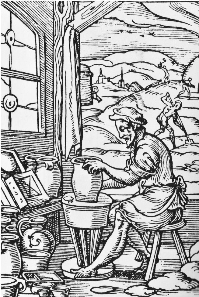
11 Ein Töpfer an der fußbetriebenen Blockscheibe, nach einem Holzschnitt von Jost Amman im 1568 erschienen Ständebuch (Ruppel 1991a, 80).
