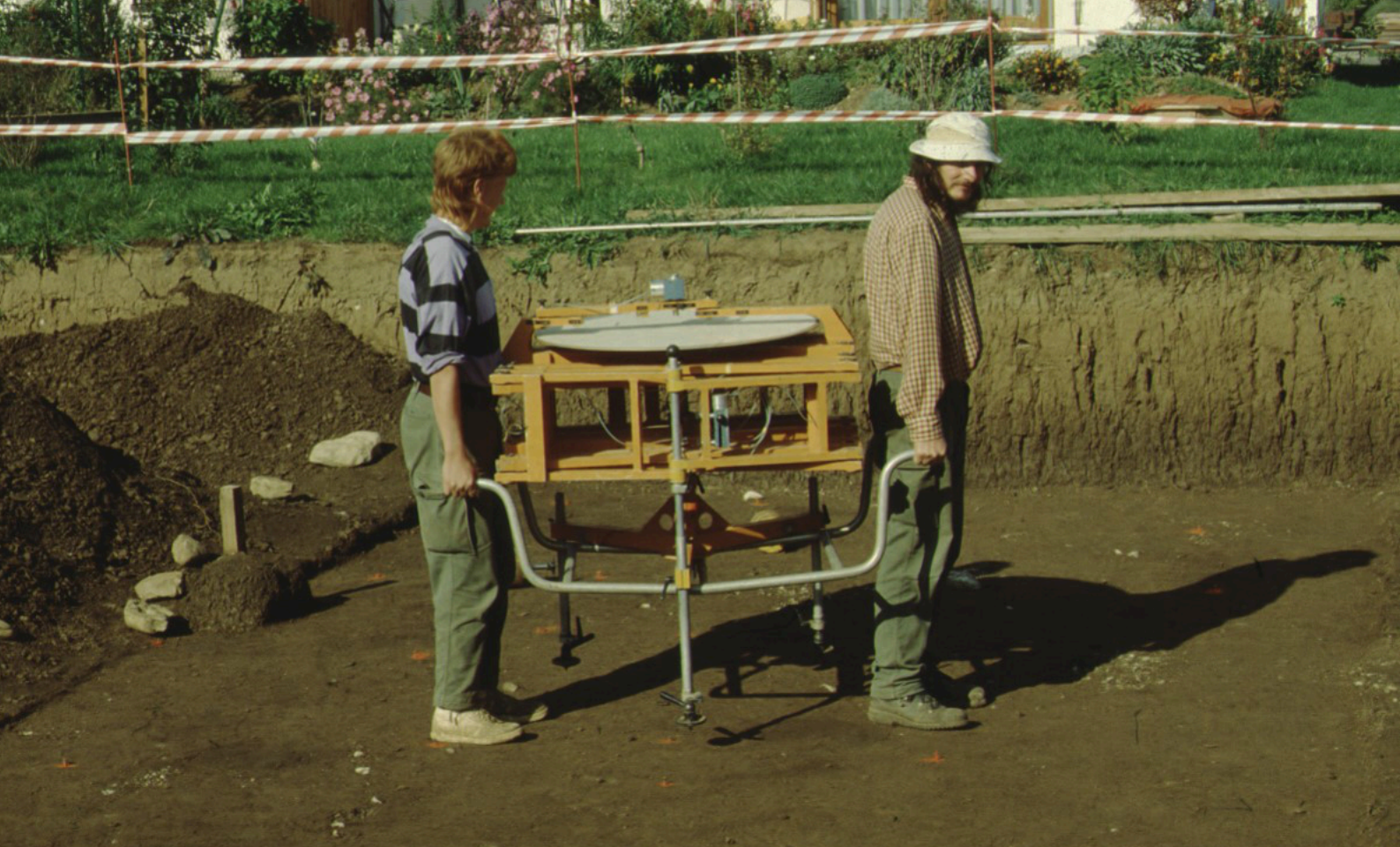
1 Der 1975 entwickelte Kartomat lieferte verzugsfreie Bleistiftzeichnungen. Die große Ausführung des Kartomaten 04 musste aufgrund seines großen Gewichts allerdings zu zweit mit Hilfe eines Tragegestells transportiert werden (Foto: H. Stickl).
