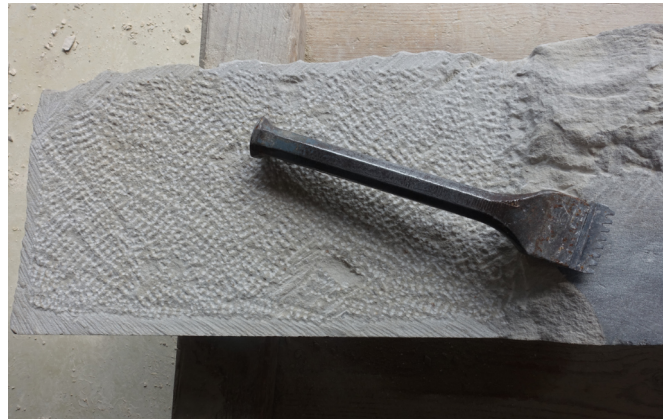
8 Gezant mit eigens eingearbeitetem Bauer (Foto: Heiko Steinwand).
