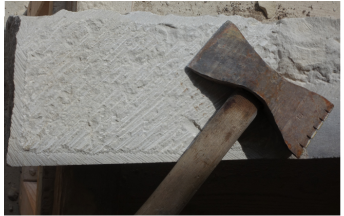
7 Fläche oder Steinbeil wurden ab der Gotik eingesetzt zur Einebnung insbesondere großer Oberflächen (Foto: Heiko Steinwand).
