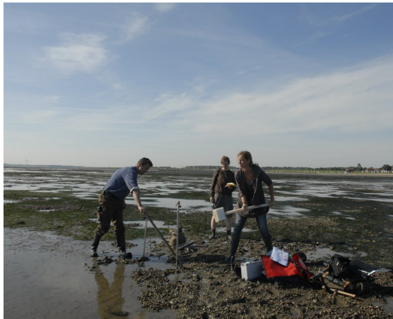
Abb. 6: Geologische Bohrungen im Watt vor Horumersiel zur näheren Ansprache der Sedimente. Blaue Balje, Küstenmeer Region Weser-Ems, Nordsee (Foto:NIHK)
