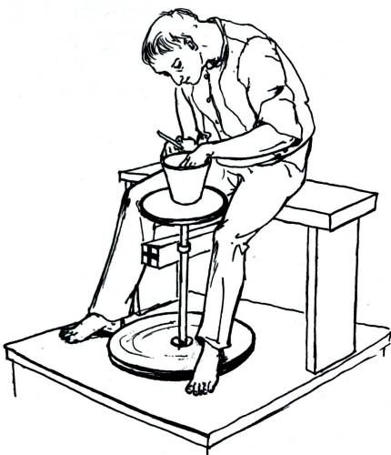
17 Abbildungsschema einer Drehscheibe mit Fußantrieb (Goebels 1985, 65).
