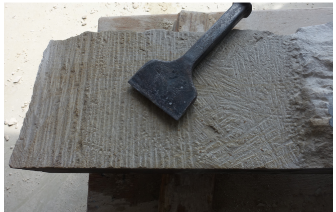
9 Von links nach rechts: Versuch eines Hamburger Doppelschlages, bahnscharriert, buntscharriert (Foto: Heiko Steinwand).
