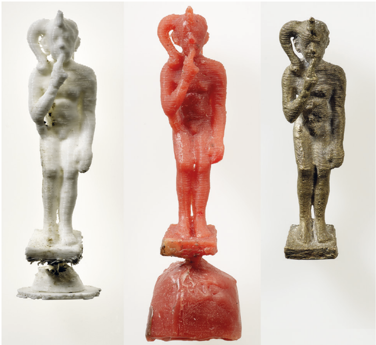
Abb. 27 Der Hohlraum aus Gussform BoS QH 207/42 als 3D-Druck, Wachsmo­dell und Bronzefigur. Größe der Bronzefigur 7,2 cm. – (Aufnahme J. Vogel, LVR-LandesMuseum Bonn; J. Auenmüller; M. Fitzenreiter).
