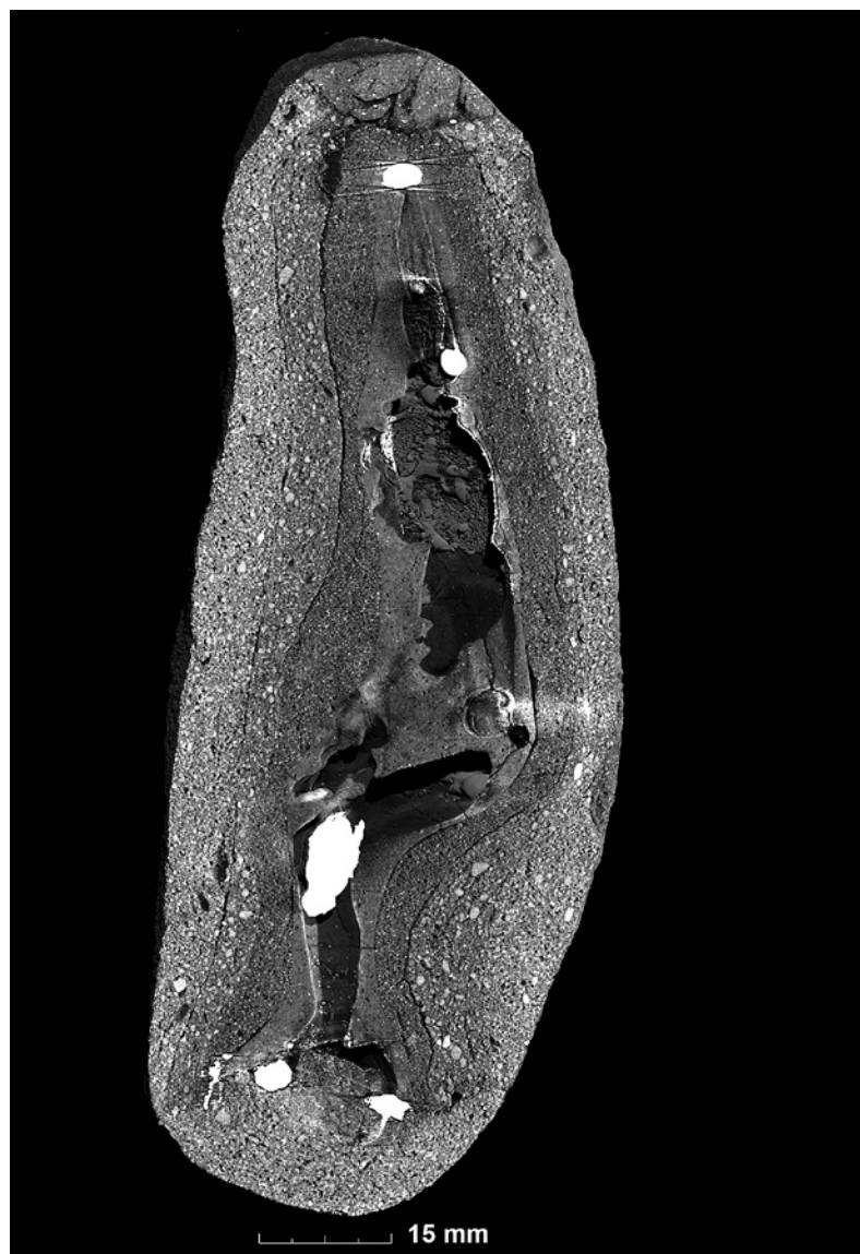
Abb. 16 CT-Schnitt der Gussform BoS QH 207/43 für eine Figur der Isis mit Kind, Höhe der Gussform 13,3 cm. Fehlguss, mit geringen Bronzeresten (helle Zonen). – (Aufnahme D. Meinel, J. Auenmüller).
