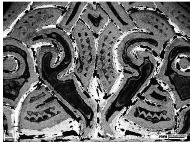
Abb. 15 Rasterelektronenmikroskopische Aufnahme der Knaufmitte mit Kerbschnitt, Vergoldung (weiß) und Nielloeinlagen (dunkelgrau bis schwarz). – (Foto REM/RE-Bild R. Schwab).
