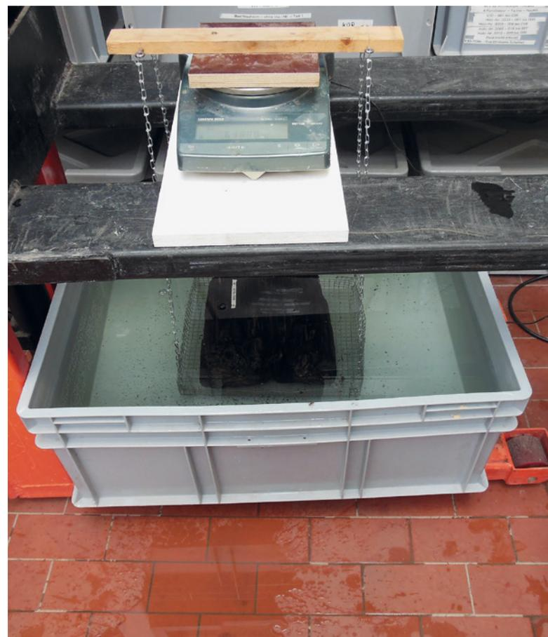
**Abb. 2** a Wägung an der Luft. – b Wägung unter Wasser. – (Fotos S. Kaiser).
