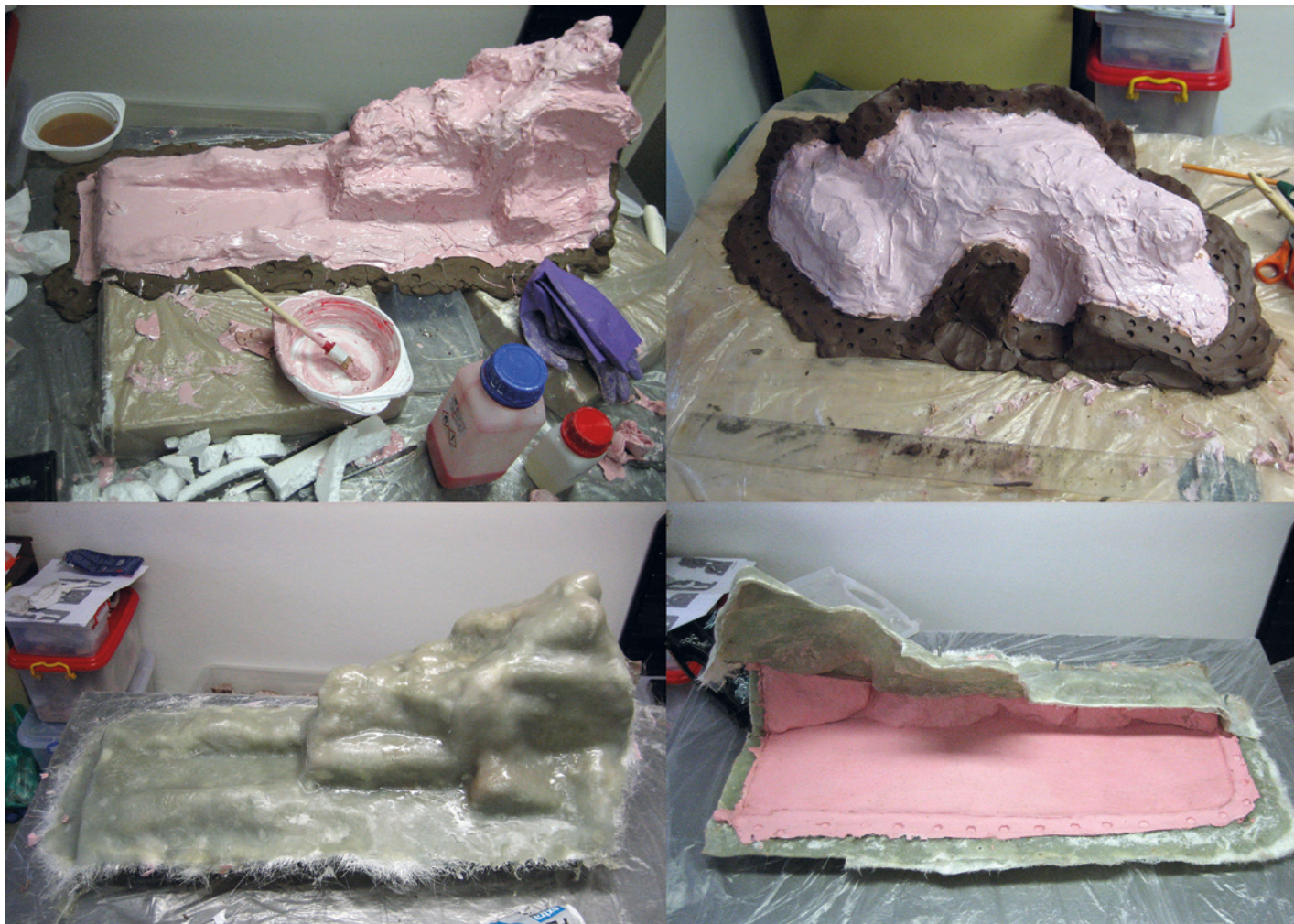
Abb. 13 Formenbau mit Ton (braun), Silikon (rosa) und Harz-Glasfaser-Kappen (grün). – (Foto A. Gatzsche).
