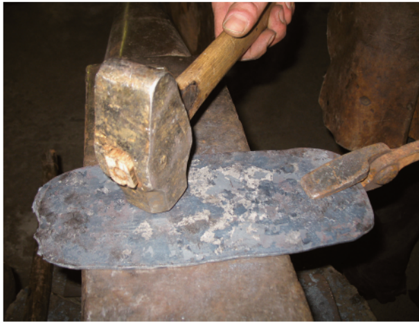
Abb. 8 Gleichmäßiges Zurichten des Blechs mit einem schweren Handhammer.
