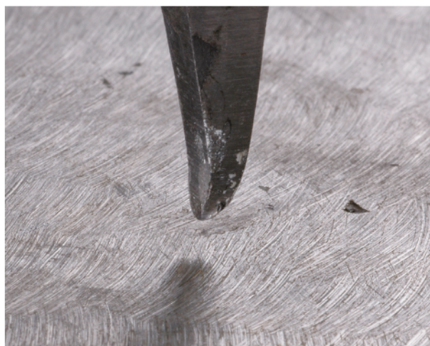
Abb. 11 Nach dem Treffer zeigt das rekonstruierte achtlagige Eisen keine Beschädigung. Das Projektil ist jedoch verformt.
