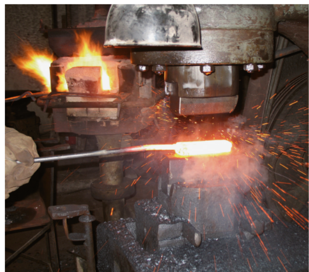
Abb. 7 Grobes Ausschmieden des dreimal verschweißten Rohlings mit einem Hammerwerk.
