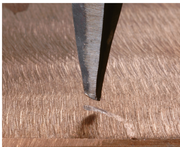
Abb. 12 Am Bronzeblech ist ebenfalls keine sichtbare Beschädigung entstanden.
