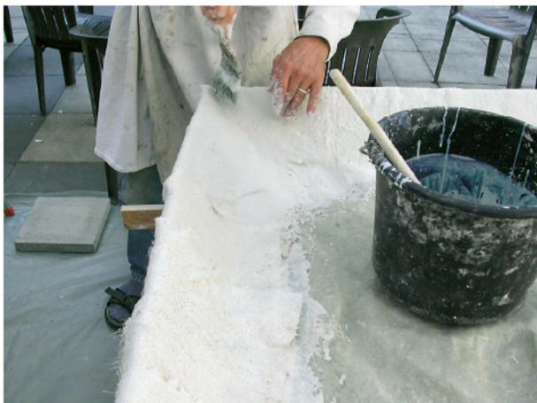
**Abb. 18** a Einpassen der Styrodur- Eckelemente. – b Aufgelegte mit Polydur getränkte Glasfasermattenstreifen. – c Einlaminieren der Styrodur-Eckelemente.
