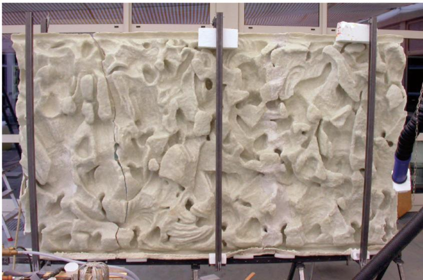
**Abb. 17** Zusammenfügen der Frontseite in einer Lehre. – a Vorderseite – b Rückseite.
