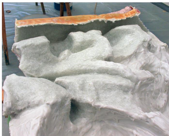
Abb. 14 Feinschichten mit teilweise aufgetragener Kupplungsschicht.
