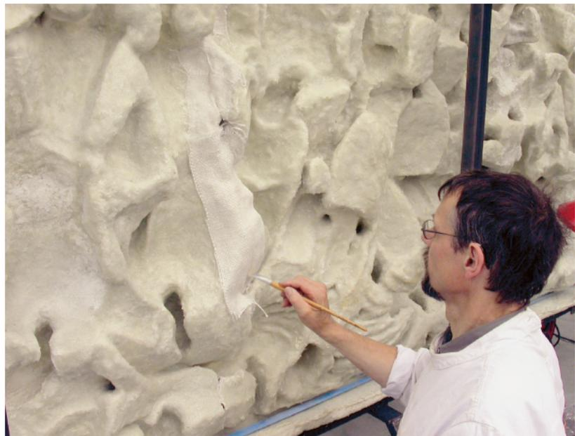
Abb. 16 Verbinden der Einzelteile von der Rückseite her mit Glasgewebe und Epoxydharz.
