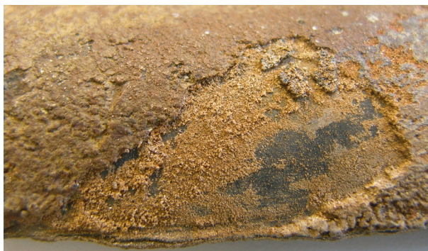
Abb. 7 Verlust der gelockerten Silberchloridschicht durch Bildung einer Zwischenschicht aus reduziertem, kristallinem Silber.
