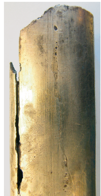
Abb. 18 Verschmiedete Hartlötlötung auf der Rückseite der vierkantigen Beinschäfte.
