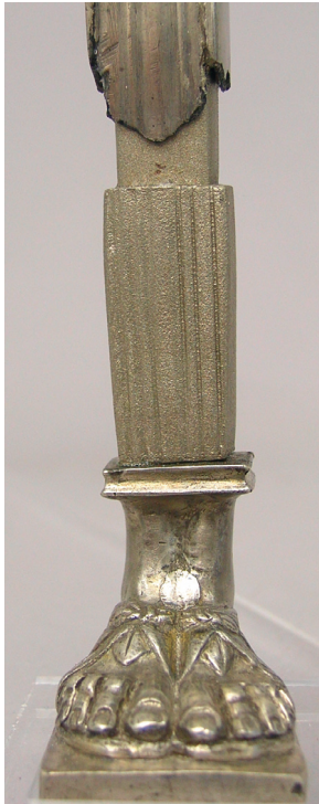
Abb. 14 Fußmanschette aus koloriertem Epoxydharz zur Verbindung von Tischbein und Fuß.
