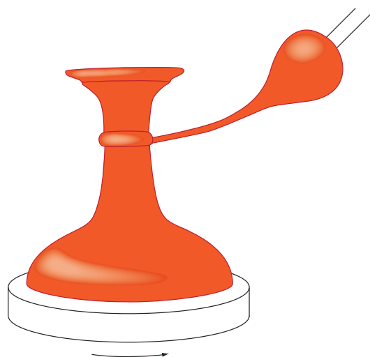
Abb. 23 Die Herstellung der Amphoramanschette durch Aufspulen eines Glasfadens.
