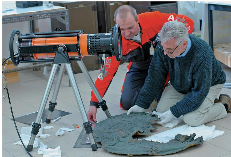
**Abb. 6** Olympia B 9600. Positionierung eines Schilddetails auf dem Röntgenfilm. Heiko Riemer (ehemals Firma Applus RTD) und Hermann Born am 23. März 2008 (Foto S. Bocher, Deutsches Archäologisches Institut, Berlin).
