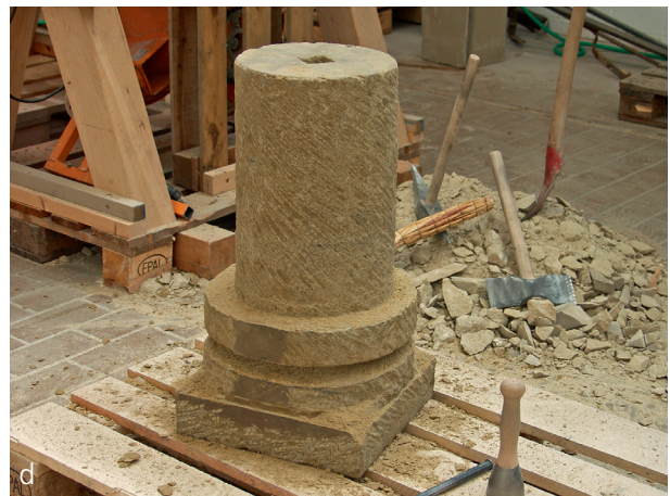
Abb. 21 a-d Zurichtung eines Rohblockes für eine Säulenbasis (Fotos Th. Flügen, Archäologisches Museum Frankfurt).
