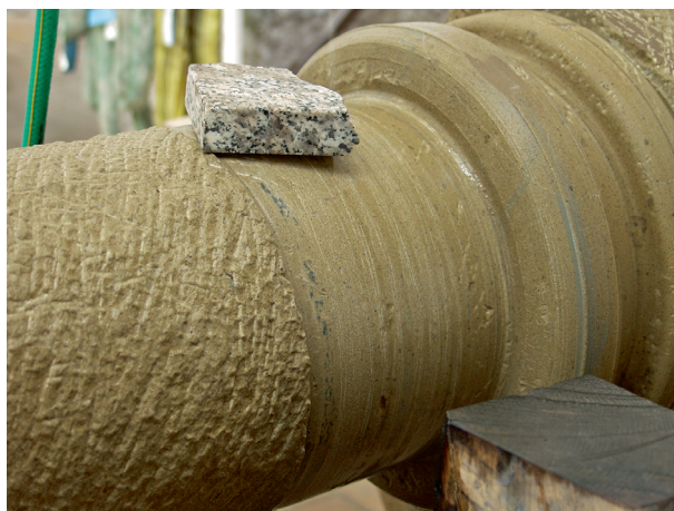
Abb. 26 Das Glätten der abgedrehten Oberfläche mit Schleifsteinen (Foto Th. Flügen, Archäologisches Museum Frankfurt).
