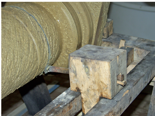
Abb. 23 Das Eindrehen von gleichmäßigen, umlaufenden Rillen (Foto Th. Flügen, Archäologisches Museum Frankfurt).
