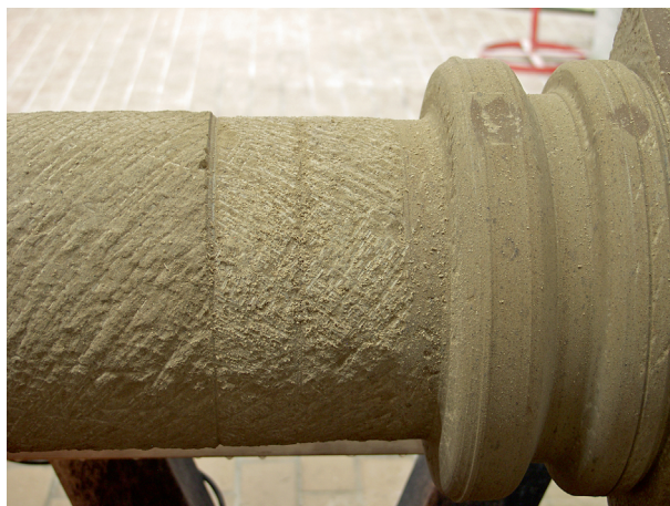
Abb. 24 Das Abarbeiten der Flächen zwischen zwei Rillen (Foto Th. Flügen, Archäologisches Museum Frankfurt).
