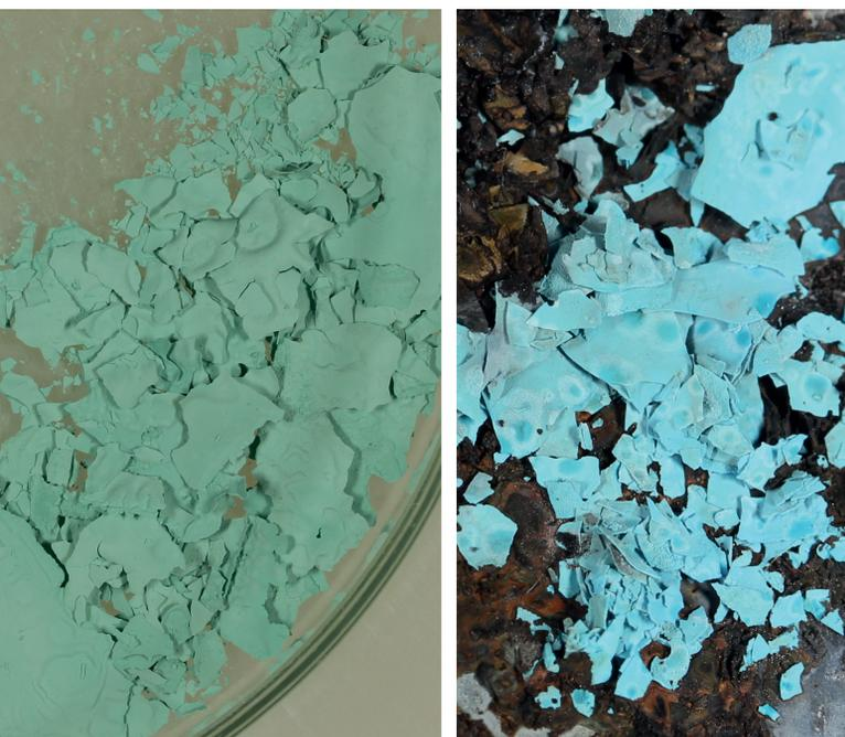
**Abb. 14** Chloridkorrosion vor (links) und nach (rechts) der Reduktion eingeschlagen in ein Stück Zinkblech. – (Fotos A. Maier).
