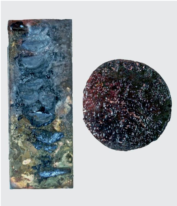
**Abb. 12** Coupon 1 und Münze 1 direkt nach der Reduktion, noch nicht abgebürstet und ausgelaut. – (Foto A. Maier).
