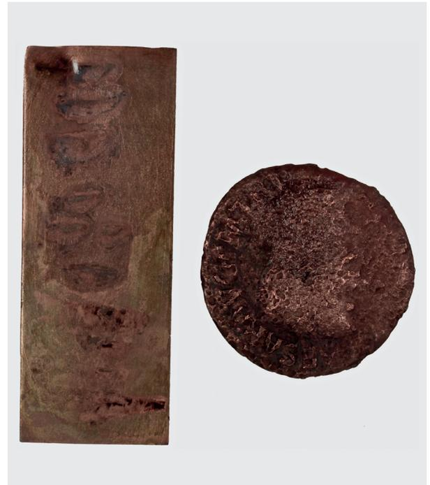
**Abb. 13** Coupon 1 und Münze 1 nach dem Auslaugen mit reduzierter Oberfläche. – (Foto A. Maier).
