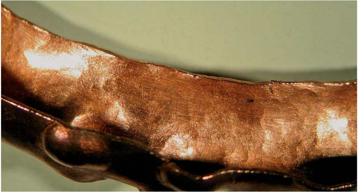
Abb. 2 Innenseite des Armrings der in der von Müllauer und Ramsel beschriebenen Herstellungstechnik nachgearbeitet wurde. Durch die Bearbeitung von der Innenseite ist diese durch deutlich erkennbare Hammerschläge verdichtet (Foto J. Munir, RGZM).
