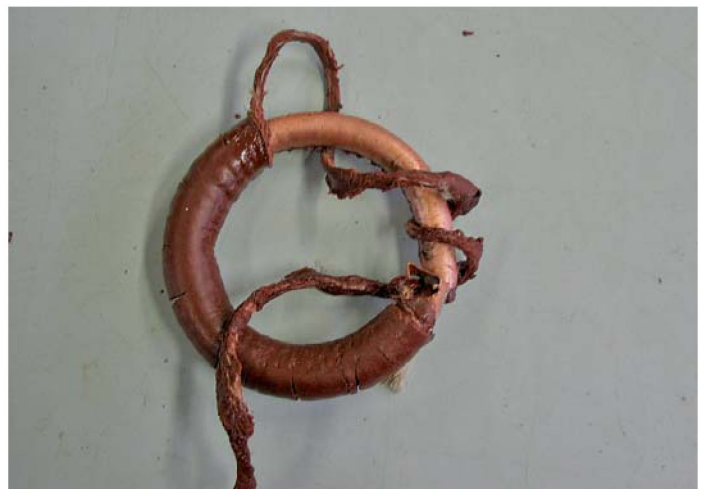
Abb. 20 Leicht erwärmt ließ sich die »Kittschnur« problemlos wieder abwickeln und war danach sogar für weitere Biegeversuche verwendbar (Foto J. Munir, RGZM).
