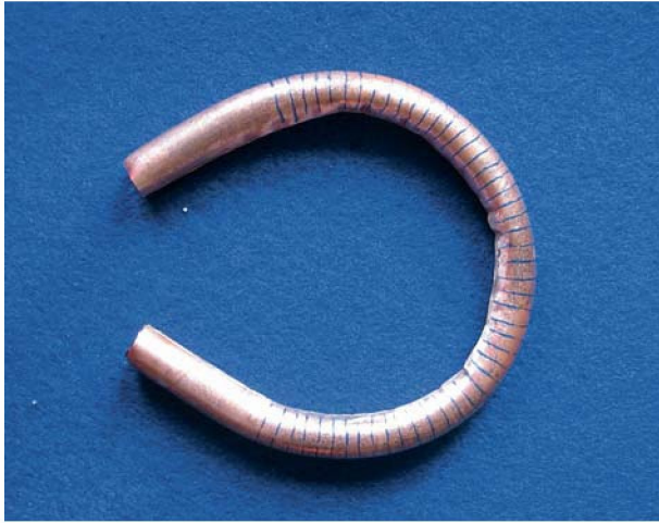
Abb. 16 Mit Kitt gefüllte Röhre nach dem Biegen. Die Knicke sind durch Luftblasen, die beim Einfüllen des Kitts entstanden sind, erzeugt worden (Foto J. Munir, RGZM).
