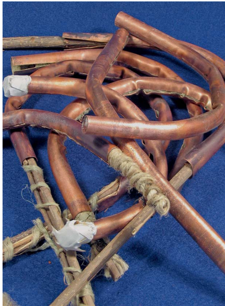
Abb. 11 Eine Reihe an Fehlversuchen war nötig, um sicherzugehen, dass organisches Füllmaterial wie z.B. gebündelte Zweige oder Textil nicht genügend Stabilität aufweisen, um eine Röhre mit offener Fuge faltenfrei zu biegen (Foto J. Munir, RGZM).
