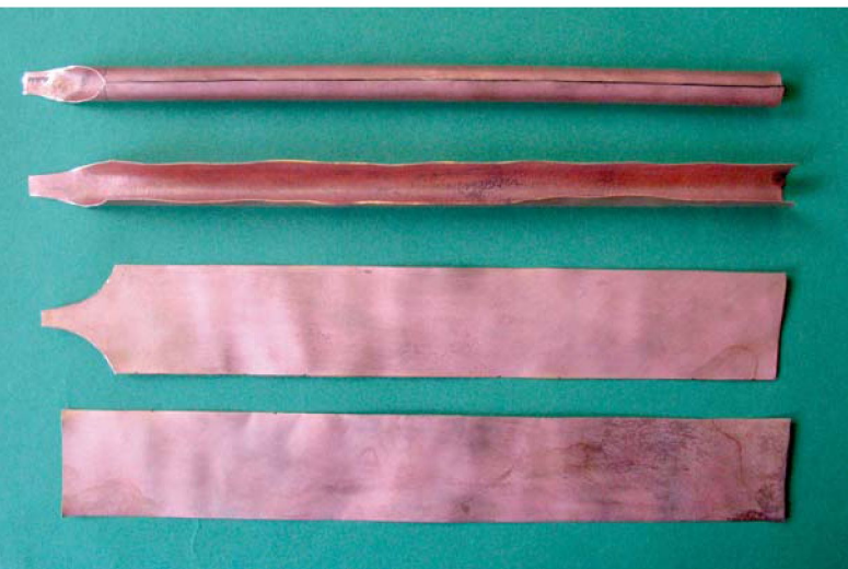
Abb. 9 Für die Versuchsstücke wurden Streifen aus Kupferblech entsprechend der Maße des Originalreifs zurechtgeschnitten. Zunächst wurden sie in eine halbrunde Form gebracht. Die Spitze an einem Ende der Bleche dient als Ansatz zum Ziehen der Rohre durch Bohrungen in einem Werkholz, welches im Sinne eines Zieheisens für Metalldrähte funktioniert (Foto J. Munir, RGZM).
