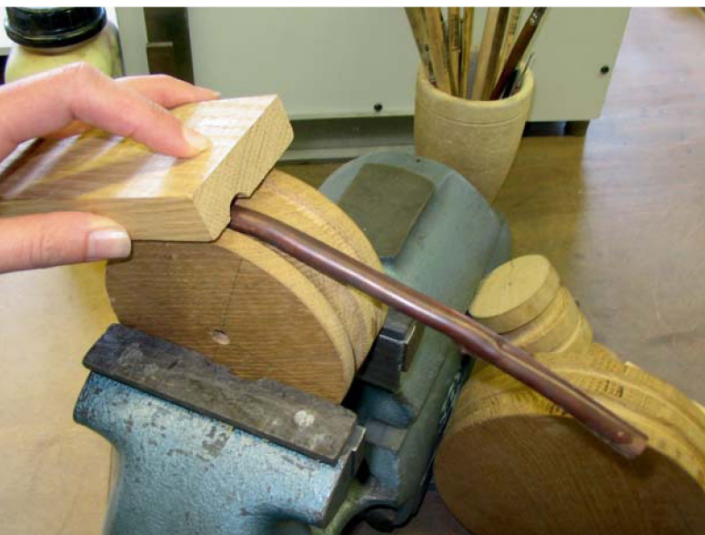
Abb. 10 Biegen einer Kupferröhre mit Hilfe der Holzkonstruktion (Foto J. Munir, RGZM).
