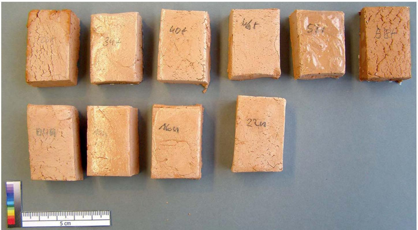
**Abb. 7** Die Versuchsstücke beispielhaft, die mit 10%-igen Konzentrationen mit der Pipette behandelt wurden. Obere Reihe von links nach rechts (trockene Keramik): Luviskol VA64, Primal WS24, Carbofet 514H, Archäofix N2000, Mowital B30H und Paraloid B72; untere Reihe von links nach rechts (feuchte Keramik): Luviskol VA64, Primal WS24, Carbofet 514H und Archäofix N2000 (Foto S. Beck).
