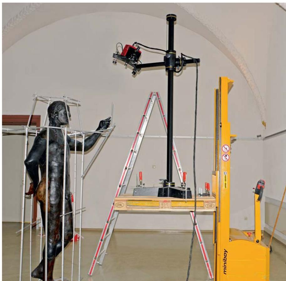
**Abb. 2** Aufnahmearbeiten an einer der Königstatuen aus dem Jemen mit einem Streifenlichtprojektionsscanner (Foto F. Roth).
