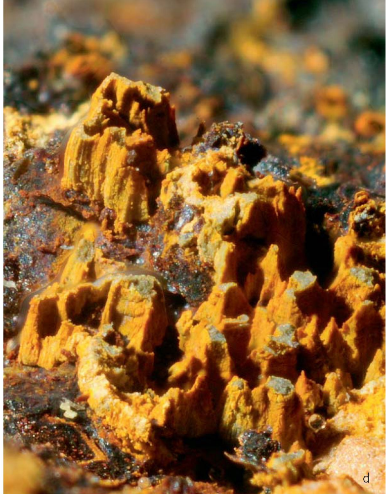
Abb. 5 a-c »Akaganeitpilze«: Warum zerfällt unser Eisen eigentlich? Im Falle des Akaganeitbäumchens wurde eine segmentale Schärfe- stapelung erzeugt. Die Höhe der »Felswand«, also der abgesprengten Korrosionsschichten (Magnetit, Limonit), liegt bei 1,5 mm. Die Akaganeitsäulen wachsen vom Eisenkern empor und drücken die darüber liegenden Schichten weg. – d Akaganeit. Die Säulenlandschaft ist hier auf der Unterseite einer abgesprengten Rostscholle entstanden, Breite etwa 2 mm (Fotos D. Bach).
