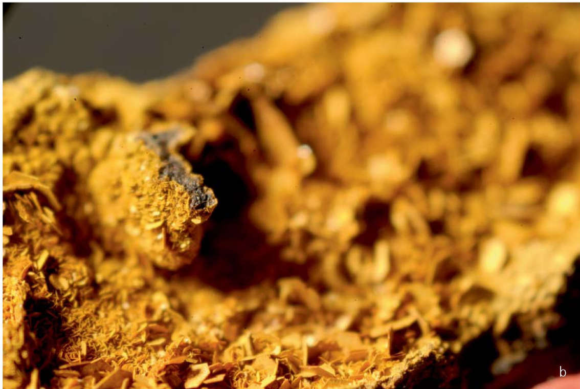
Abb. 4 a Lepidokrokit im Inneren einer Rostblase. Das Bild wurde aus 170 Einzelfoklen errechnet. Die notwendigen Mikroschritte von etwa 0,02 mm Weite wurden mit einem manuellen Präzisions-XYZ-Lineartisch von Newport ermöglicht. Das gesamte entstandene Datenvolumen für diese Aufnahme liegt bei mehr als 5 GB! Die Gesamtbreite der Aufnahme beträgt etwa 4 mm. – b Zum Vergleich eine Einzelaufnahme bei Blende 8 mit verschwindender Tiefenschärfe (Foto D. Bach).
