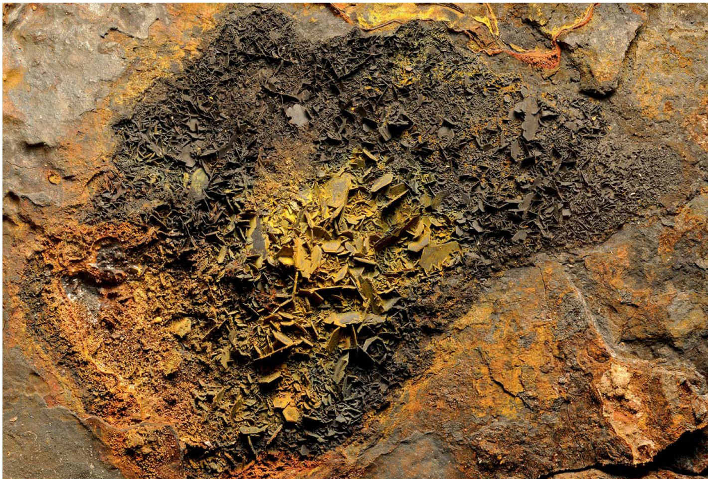
Abb. 6 »Lepidokrokitnest« unter einer abgesprengten Blase auf einer römischen Lanzen Spitze. Das Foto wurde aus drei Segmenten erstellt, die jeweils wieder aus etwa 20 Fokusschritten errechnet worden waren. Die Gesamtauflösung liegt bei 25 Millionen Pixel. Breite der unteren Bildkante ca. 20mm (Foto D. Bach).
