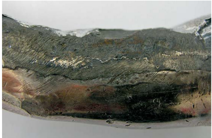
Abb. 4 Rechter Arm mit sichtbarer Silberblechkante innerhalb des Weichlotes (Foto B. Niemeyer).
