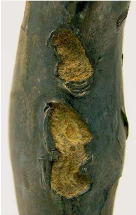
Abb. 3 Verlorene Flächen an zusammengeschobenen Silberblechpartien (Foto B. Niemeyer).
