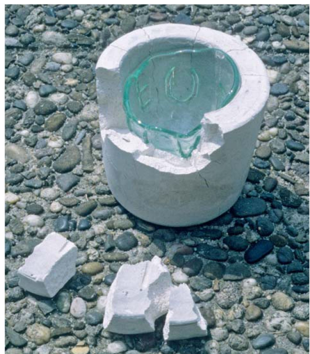
Abb. 31 Zerfallende Gipsform mit blankem Reliefpressling (Foto R. Lierke).
