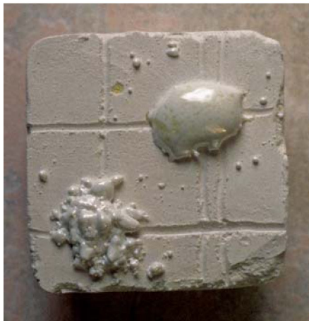
Abb. 35 Glaspulver gleichzeitig mit und ohne Bleioxydzusatz erhitzt. Das Glaspulver mit Bleizusatz ist bereits völlig verschmolzen. Die hohe Oberflächenspannung des geschmolzenen Glases bewirkt, dass es sich mit glatter Oberfläche zusammenballt, ohne am Gips zu haften (Foto R. Lierke).
