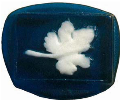
Abb. 39b Experimentelle Kameoplatte (1995), der Kameodekor sitzt auf einem dunklen Sockel und hat sich an den Spitzen des Blattes zurückgezogen (vgl. BM Katalog Nr. 8 und Nr. 33) (Foto R. Lierke).
