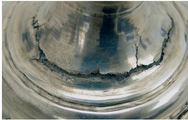
Abb. 17 Blick auf die korrodierte Weichlotfüllung im Fuß des Bastelkesselchens. Die unregelmäßige dunkle Linie darunter ist die Lotnaht, die von einer eingedrückten Rille kaschiert wurde (vgl. Abb. 16b). – (Foto B. Niemeyer).
