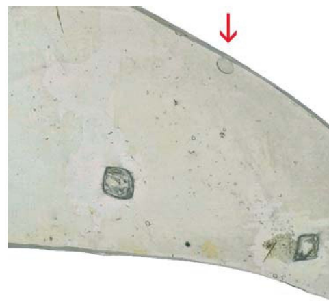
Abb. 4 Ausschnitt von der Innenseite des Fragmentes mit halbrund erscheinendem Stegquerschnitt und flachgedrückter Luftblase (Foto Th. Zühmer, Rheinisches Landesmuseum Trier).
