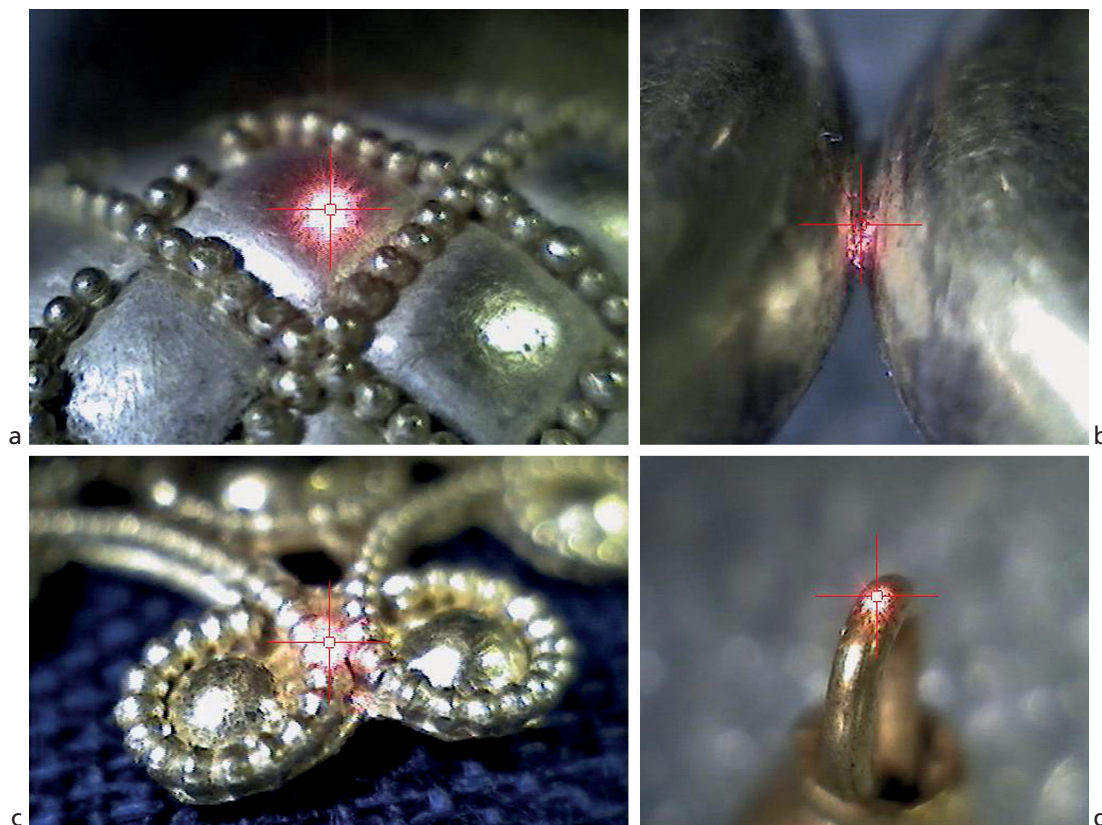
Abb. 26 Messstellendokumentation bei der atmosphärischen Röntgenfluoreszenzanalyse: a auf dem Körper der Raubvogelfibel Kat. 1. – b an der Lötung einer Astragal-Doppelspule Kat. 3. – c auf dem Perldraht von Schalenspiralapplik 1 Kat. 6. – d an der Öse des tropfenförmigen Anhängers Kat. 9. – (Fotos O. Hahn).
