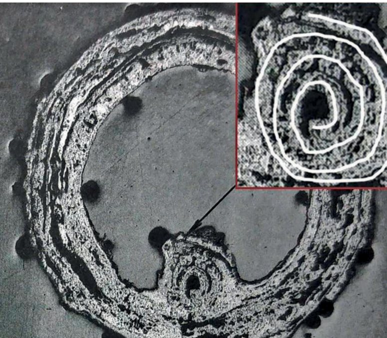
Abb. 8 Anschliffbild zweier Ringglieder aus dem Kettenpanzer von Zemplín. Im Querschnitt ist der spiralförmige Aufbau deutlich erkennbar (s. Detail oben rechts mit Umzeichnung). – (Nach Longauerová/Longauer 1990, Abb. 3, 2).
