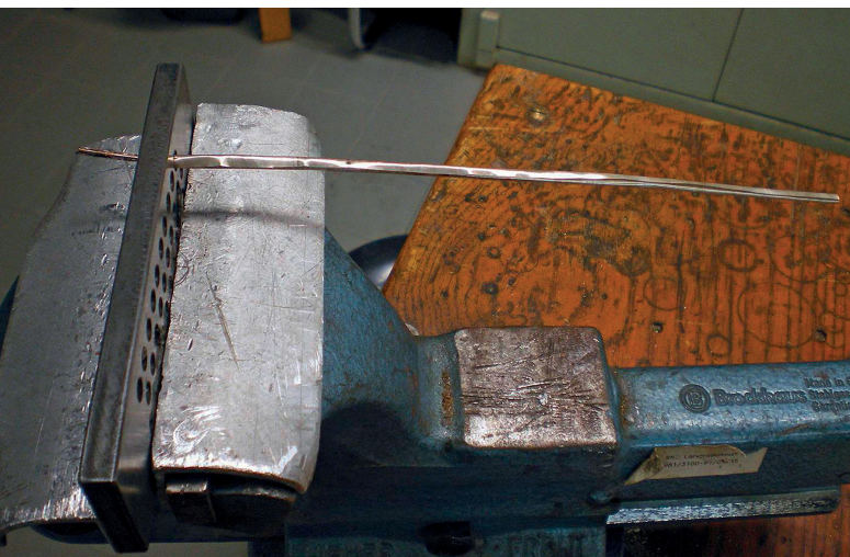
Abb. 11 Eingerollter Kupferblech-Draht mit verjüngter Drahtspitze vor dem ersten Ziehen durch das 3 mm breite Ziehhol des eingespannten Ziehheisens. – (Foto F. Willer).
