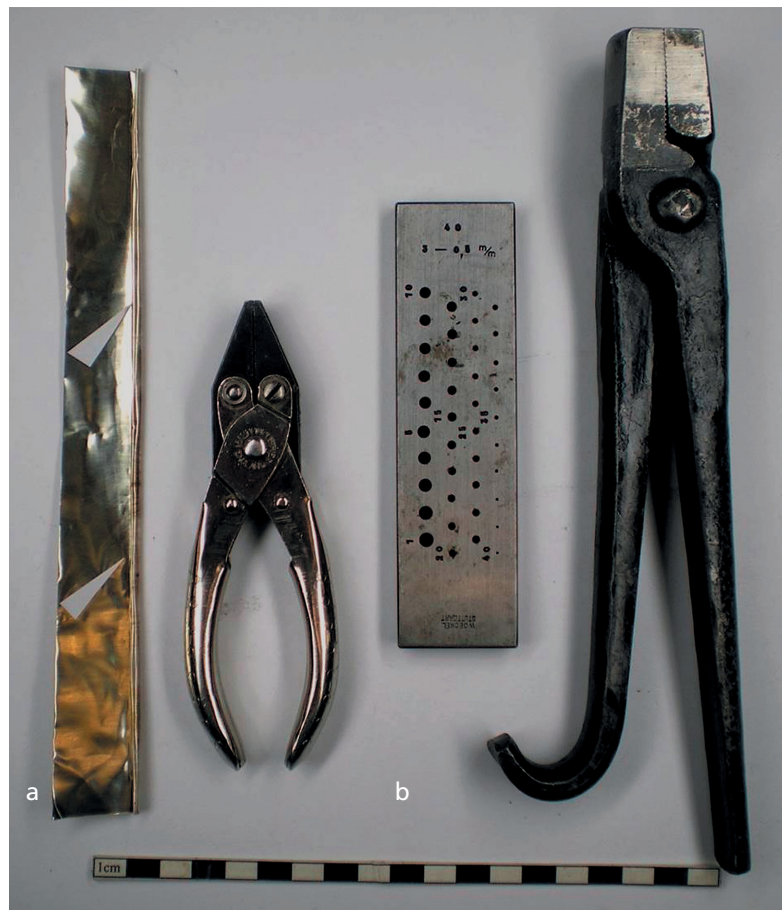
Abb. 9 a Einrollen eines 0,2 mm starken versilberten Kupferblechs mit einer Flachzange. – b Zieheisen und Ziehzange. – (Foto F. Willer).
