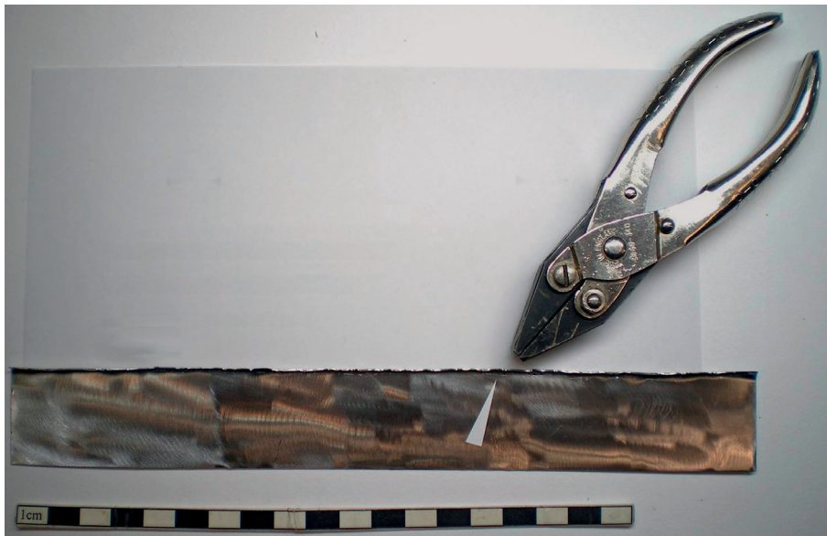
Abb. 15 Versuch mit einem 0,4mm starken und 230mm langen Eisenblech. Bördeln der Blechkante mit einer Flachzange. – (Foto F. Willer).
