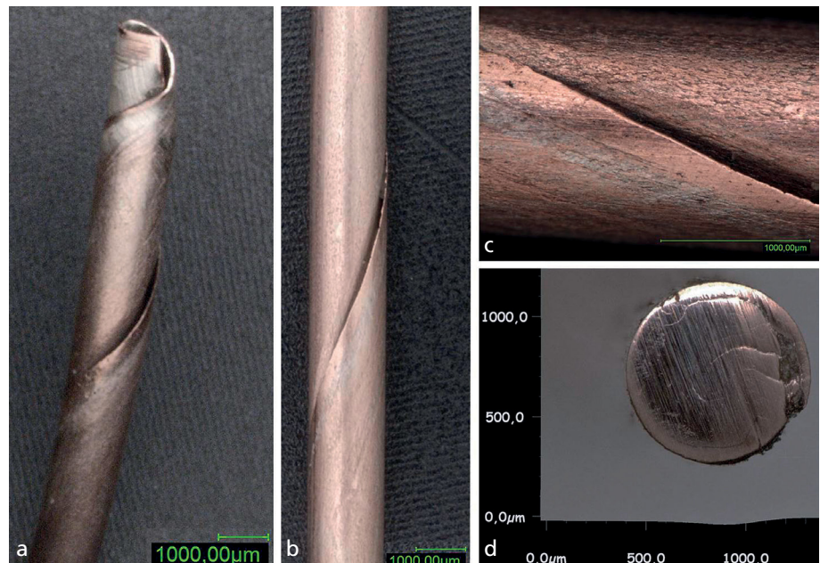
Abb. 14 a Detail des Kupferblech-Drahtendes nach dem ersten Ziehen. – b Detail der sich verdrehenden Naht in der Mitte des Drahtes. – c Naht bei 200-facher Vergrößerung. – d Querschnitt des Drahtes bei 20-facher Vergrößerung. – (Aufnahmen F. Willer).
