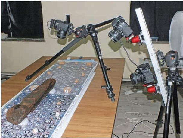
**Abb. 16** Anordnung der Kameras bei der Aufnahme mit Schlitten. – (Foto M. Lehmann).
