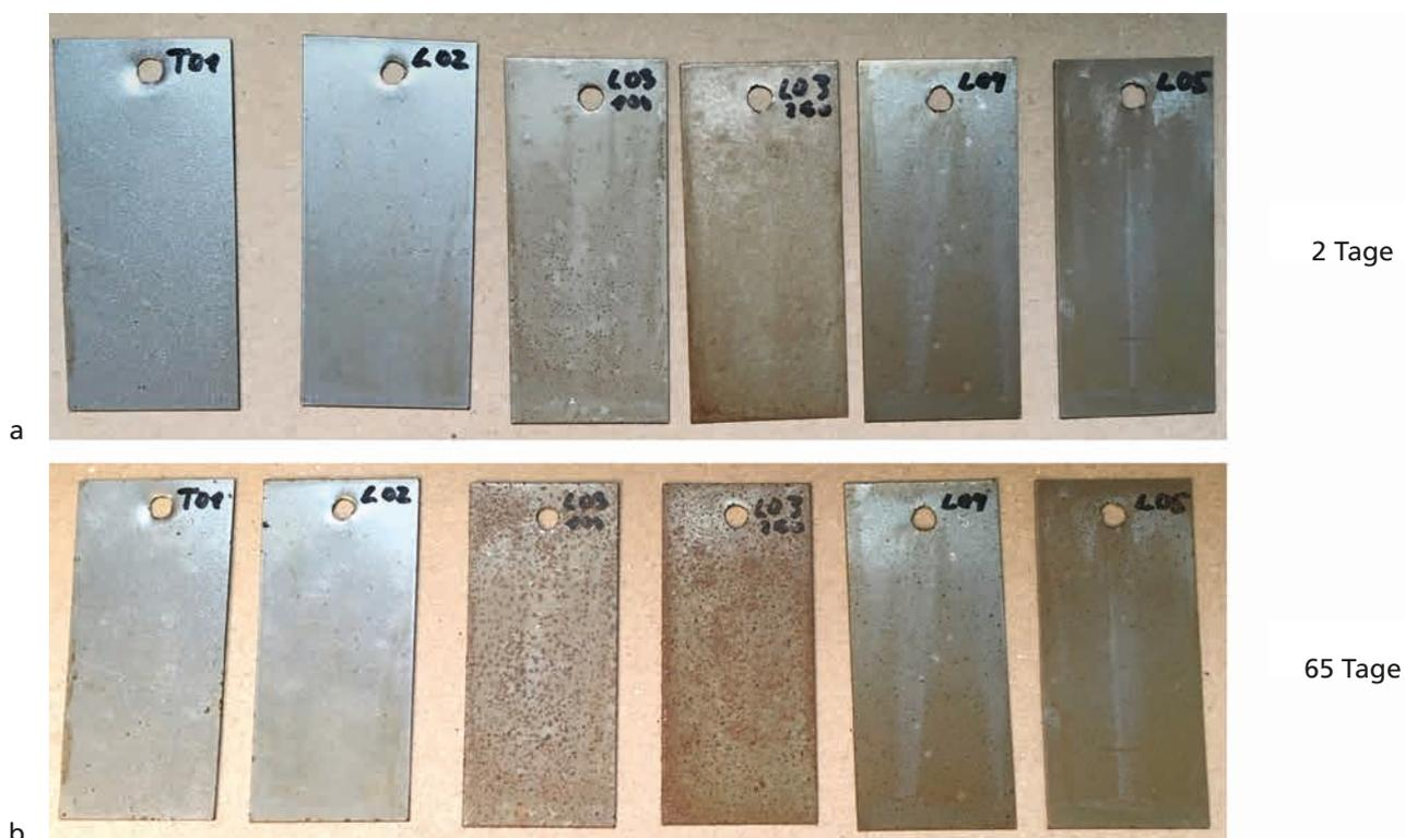
**Abb. 5** Proben nach Bewitterung bei nahezu 100 % r.h.: **a** nach 2 Tagen. – **b** nach 65 Tagen. – (Fotos B. Scherer).
