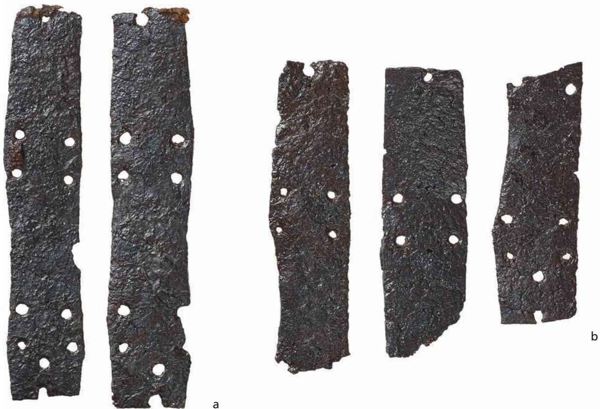
**Abb. 13** Unterschiedliche Oberflächenbeschichtungen auf Eisenlamellen eines Lamellenpanzers aus einer Grabung in Wesel-Bislich: **a** Lamellen 1 und 2/Acrylack Paraloid™ B 72. – **b** Lamellen 3-5/Stärkeester T01. – (Fotos J. Vogel, LVR-LandesMuseum Bonn).
