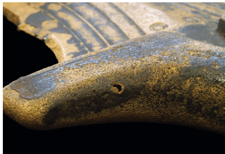
Abb. 12 Gusslunker in der Heftschulter des Schwertes aus Auvernier. Am unteren Rand der Heftflügel ist die geritzte Linienbandverzierung schwach zu erkennen. – o.M.
