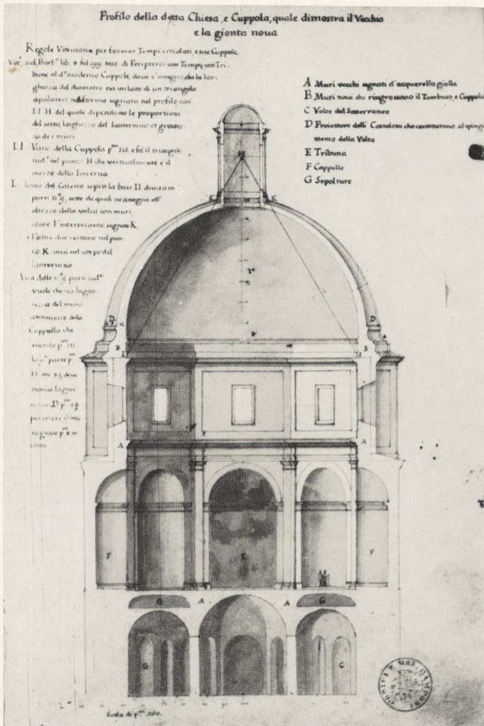
14. Montefiascone, Dom. Carlo Fontana, Querschnitt des Ausführungsprojekts (Modena, Bibl. Estense; vgl. Kat. Nr. 8)
