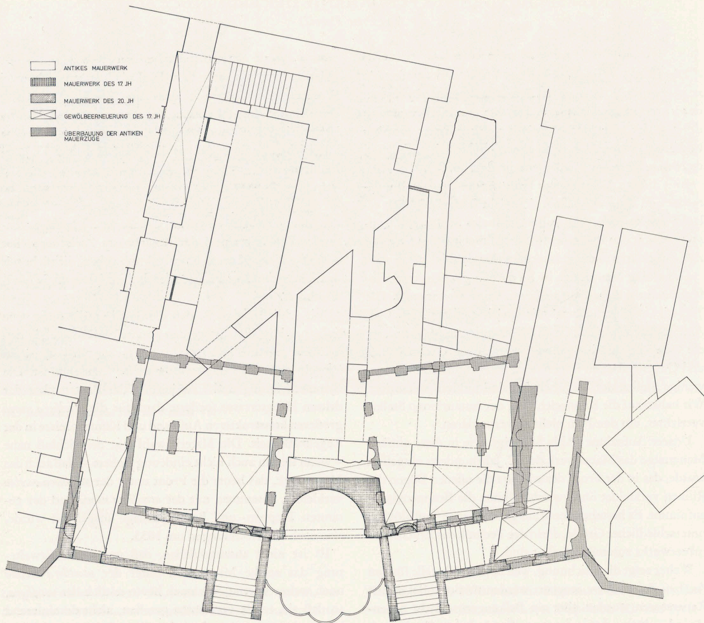
58. Antikes und modernes Mauerwerk unter den Vogelhäusern. M 1:400. Aufnahme von P. Debold
