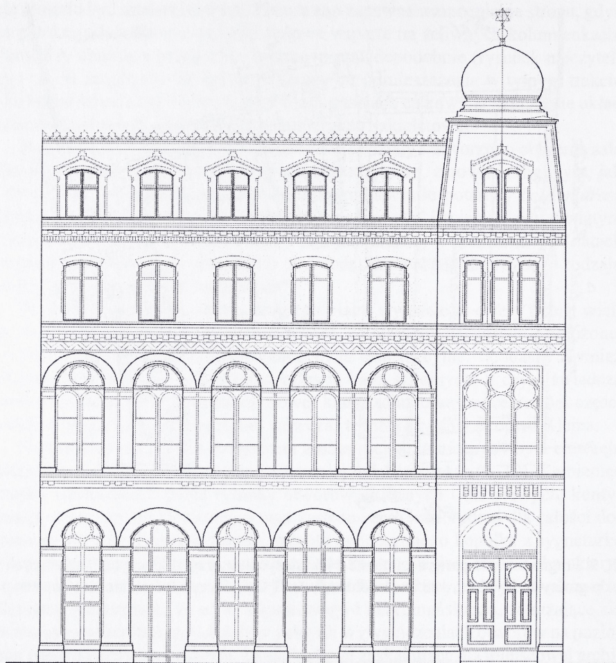
Il. 10. Rekonstrukcja fasad kamienic należących do gminy żydowskiej. Stan po przebudowie w 1885 r. oprac. autorka
