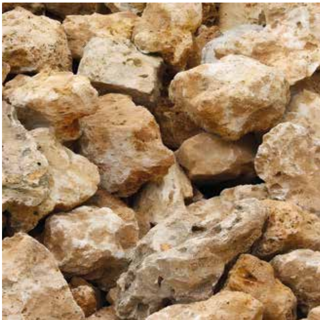
Il. 1. Przykładowy kamień okrzeskowy, źródło: https://hmt.fr/pierres-naturelles/barrettes-moellons-parement/meuliere-moellon [dostęp: 20.11.2023]
