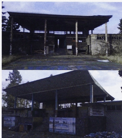
Il. 12. Ciechocinek, basen solankowy – rozwiązania analogiczne do projektu poczty: płaskie, gładkie powierzchnie elewacji, zaakcentowanie centralnej osi wejściowej, wsparcie na smukłych słupach i zaokrąglone narożniki (fot. P. Tomaszewski 2016, r.)
