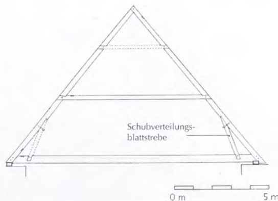
Abb. 174: Quer eingebundenes Sparrendach mit zwei Kehlbalken und Schubverteilern als verstärkende Einbauten. Markgröningen (Lkr. Ludwigsburg), Bartholomäuskirche, westlicher Abschnitt, 1348 (d).
