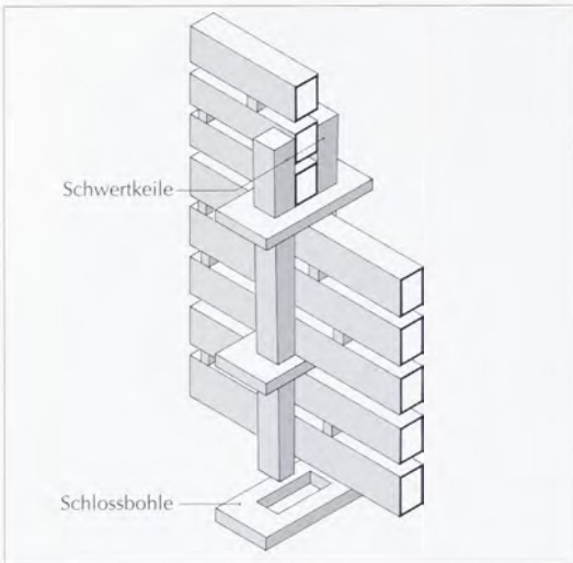
Abb. 92 (links): Blockzange mit Schwert beim offenen Blockbau.
