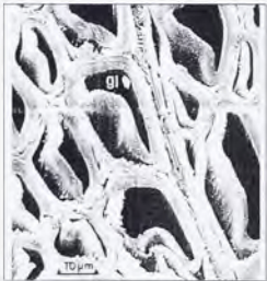
Abb. 3d: Zugholz-zellen nach dem Trocknen. Die stark verformten Zellwände weisen im getrockneten Zustand eine erheblich reduzierte Festigkeit auf.
