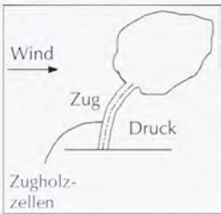
Abb. 3c: Laubholzbaum und Ausbildung von Zugholz-zellen.
