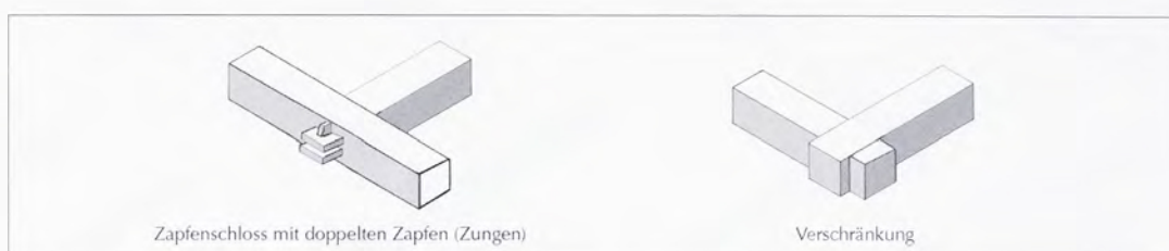
Abb. 66: Eckverbindungen mit Vorholz, die aus Quer- bzw. Überkreuzverbindungen gebildet sind.
