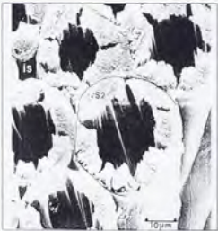
Abb. 3b: Druckholz-zellen nach dem Trocknen. In den dickwandigen Zellen sind Trocknungsrisse zu erkennen, die die Tragfähigkeit von Druckholz im getrockneten Zustand stark herabsetzen.
