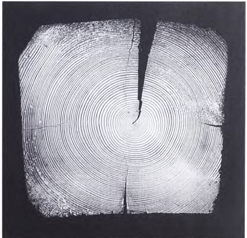
Abb. 5: Nadelholz, Vollholzquerschnitt mit Schwundrissen (radialer Riss durch tangentialen Schwund).
