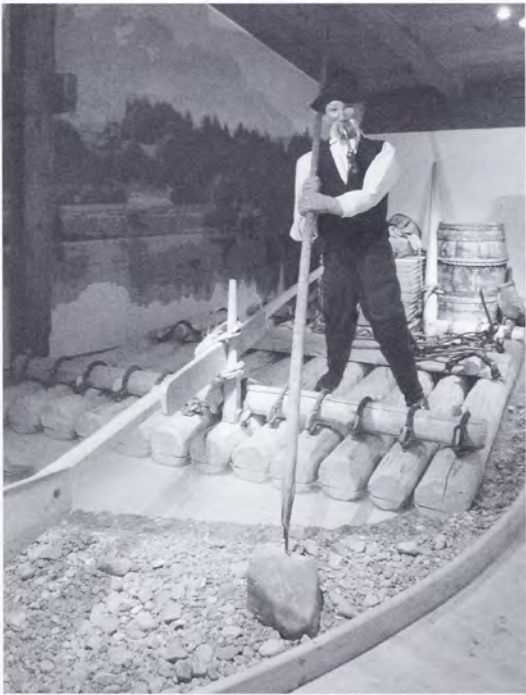
Abb. 10: Modell eines Floßes mit verkeilter Wiedenbindung, Flößermuseum Lechbruck.
