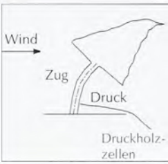
Abb. 3a: Belastung eines Nadelholzstammes und Ausbildung von Druckholz-zellen.
