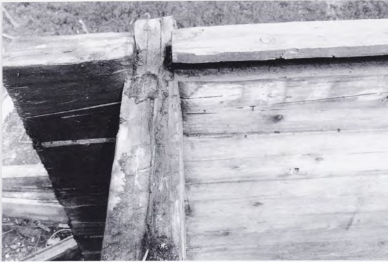
Abb. 83: Kantholzblock mit Hohlkehle für Dichtungsmaterial.
