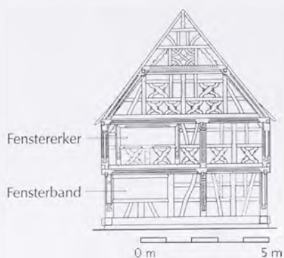
Abb. 210: Reiche Fassadengestaltung mit sich überlagernden symmetrischen Bezügen bei funktional durch die unterschiedlichen Raumgrößen bedingter asymmetrischer Bundständerstellung im Unterbau, Wyhl (Lkr. Emmendingen), Sasbacher Str. 6, 1699 (d).
