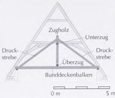
Abb. 195: Hängewerk von 1773/74 (a) in verändertem Dachwerk von 1450/51 (d), Sulmingen (Lkr. Biberach), Pfarrkirche.
