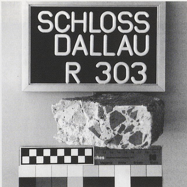
Abb. 24: Schloß Dallau, Palas der Wasserburg. Bruchstück eines im zweiten Obergeschoß noch vorhandenen historischen Estrichs der Zeit um 1600, hier mit geschliffener Kante. Im Estrich sind Splitter von gebrannter Tonware enthalten.
