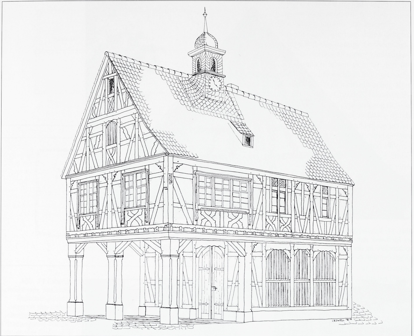
Abb. 16: Schriesheim, Rathaus. Der zeichnerische Rekonstruktionsversuch des Zustandes von 1682ff. zeigt das Rathaus als Fachwerkgebäude mit „Mann“-Figuren, Winkelhölzern und Dreiviertelstreben sowie mit Profilhölzern versehene Fenstererkern beim Großen Ratssaal im Obergeschoß. Auf der vorderen Traufseite dürften sich erdgeschossig entsprechend der Rückseite große, mit Staketen versehene Öffnungen befunden haben. Der Hauptzugang lag giebelseitig und war von der Vorhalle aus zu betreten.
