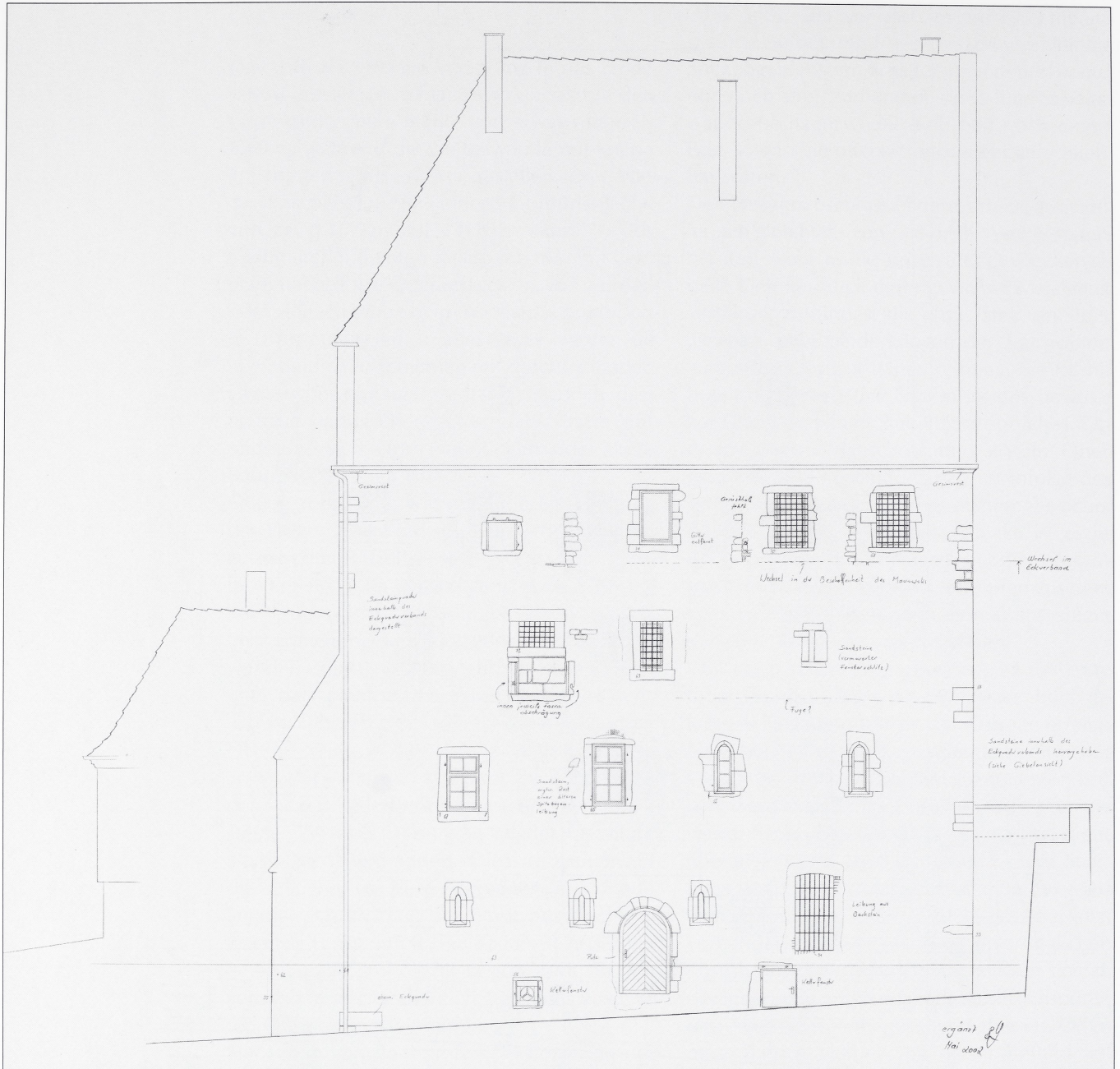
Abb. 5: Besigheim, Steinhaus. Westansicht, Bestand 2002.
