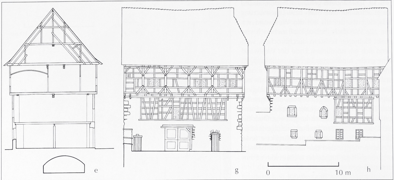
Abb. 4/2: Balin- gen, Zollernschloss. Bestandspläne des Hauptgebäudes vor dem Abbruch 1935. e Querschnitt; f Ansicht Ostseite; g Ansicht Nordseite; h Ansicht Südseite. M. 1 : 300.
