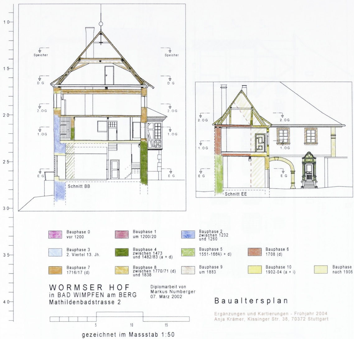
Bad Wimpfen, Wormser Hof. Querschnitt durch das Kelterhaus und den Seitenbau mit Baualterskartierung.
