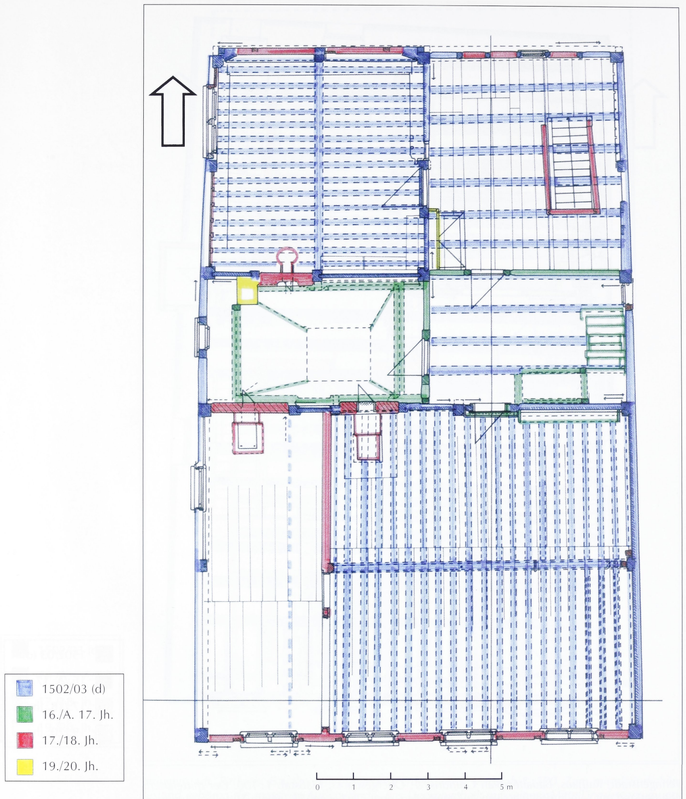
Veringenstadt, Rathaus. Baualtersplan Grundriss 2. Obergeschoss, Maßstab 1 : 100. Die mittelalterliche Fachwerkkonstruktion ist bis auf die später weitgehend erneuerte Südseite noch umfangreich erhalten geblieben. Im Planbild sind die beiden Bohlenstuben gut zu erkennen, zwischen denen der ursprünglich zum Flur hin offene Feuerungs- bzw. Küchenbereich liegt. Der Flur in der Nordostecke wurde erst nachträglich unterteilt.
