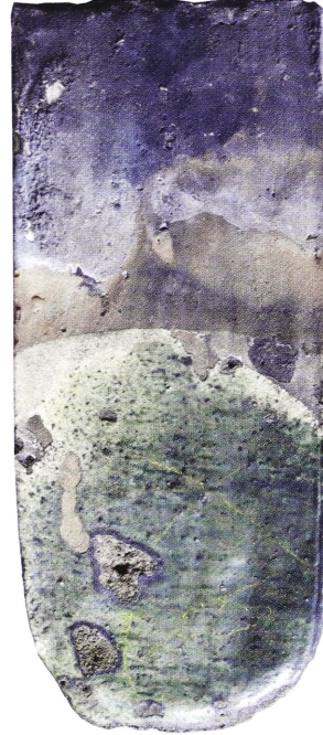
1 Salem, Münster. Südliche Dachfläche des Hochchors. Zustand 1995. – 2 Ulm, Metzgerurm. Flächenziegel der ältesten Generation. a Aufsicht, b Untersicht. – 3 Ulm, Metzgerurm. Flächenziegel der zweiten Generation. a Aufsicht, b Untersicht.
