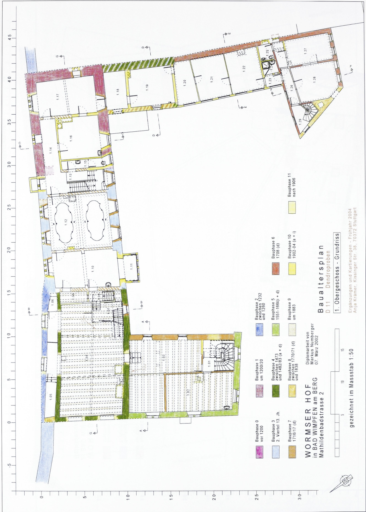
Bad Wimpfen, Wormser Hof. Grundriss des 1. Obergeschosses mit Bauhalterskartierung.
