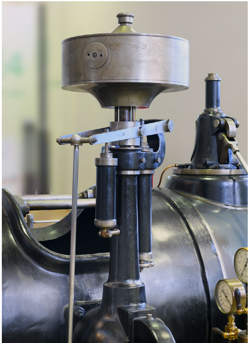
Abb. 7: Detailaufnahme des Fliehkraftreglers mit Federwage seitlich der Achse TECHNOSEUM, Foto: Klaus Luginsland
