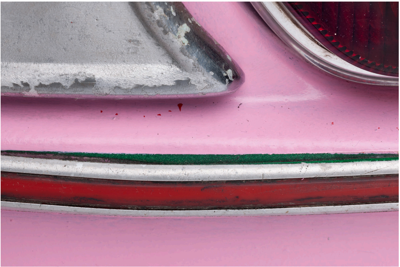
Abb. 2: Spuren einer früheren Lackierung der Autoskooter-Chaise in Grün-Metallic und Violett
