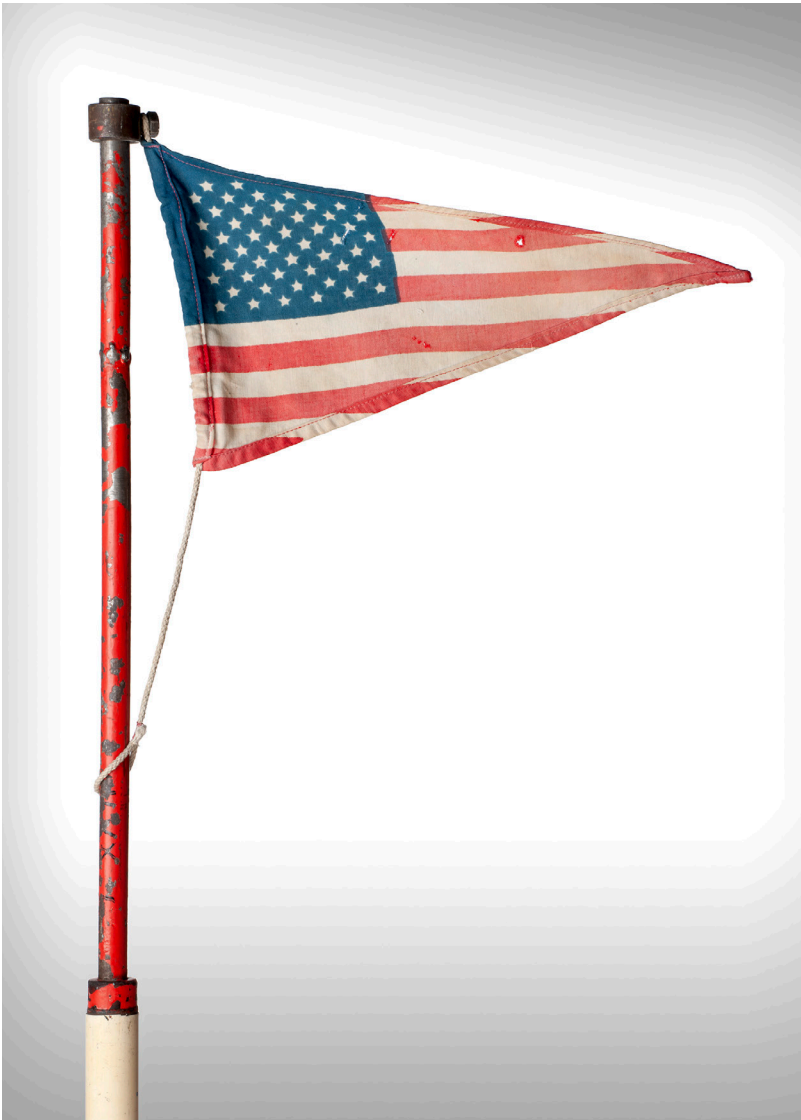
Abb. 4: Stromabnehmer der Autoskooter- Chaise mit einer wimpelförmigen amerikanischen Flagge
