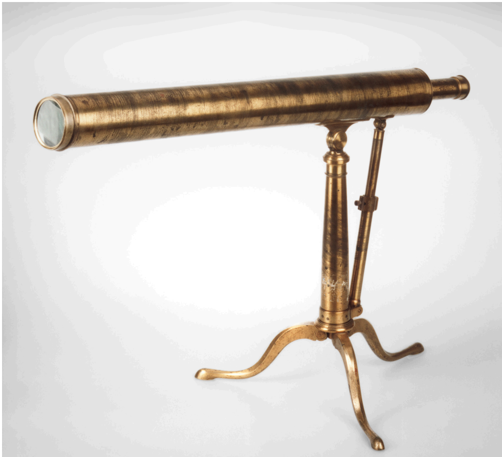
Abb. 4: Linsenfernrohr mit achromatischem Objektiv und Stativ, Jesse Ramsden, London, um 1776, EVZ: 1983/0046-003 TECHNOSEUM, Foto: Klaus Luginsland
