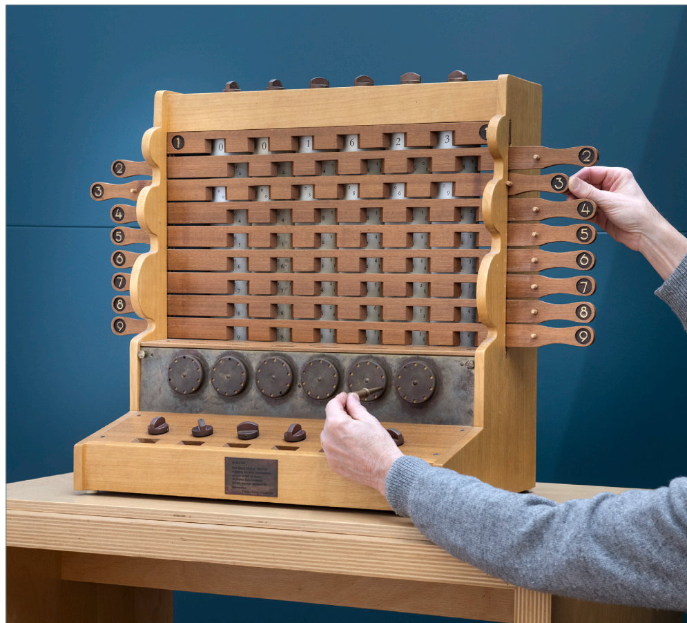
Abb. 3: Schickard'sche Rechenmaschine, rekonstruiert von Bruno Baron von Freytag Löringhoff, gebaut von Erwin Epple, EVZ: 1983/0008 TECHNOSEUM, Foto: Klaus Luginsland
