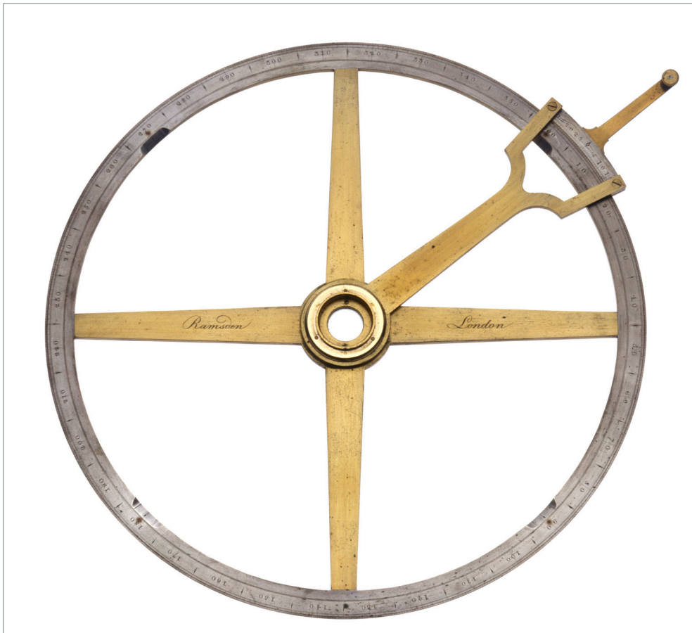
Abb. 3: Winkelmesser oder sogenannter Transporteur von Ramsden, London, um 1770, EVZ: 1983/0046-033 TECHNOSEUM, Foto: Klaus Luginsland
