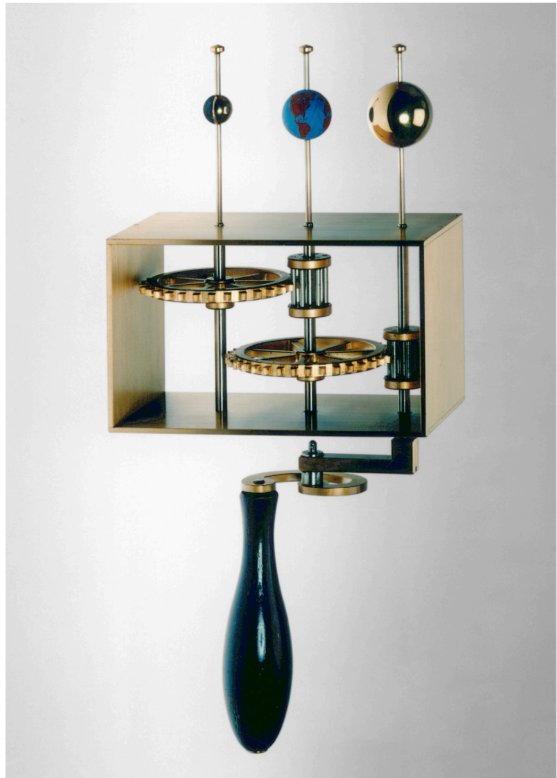
Abb. 2: Schickard'sches Handplanetarium, nach der Darstellung auf dem Porträt rekonstruiert von Ludolf von Mackensen, gebaut von Gerhard Weber, EVZ: 1983/0086 TECHNOSEUM, Foto: Klaus Luginsland
