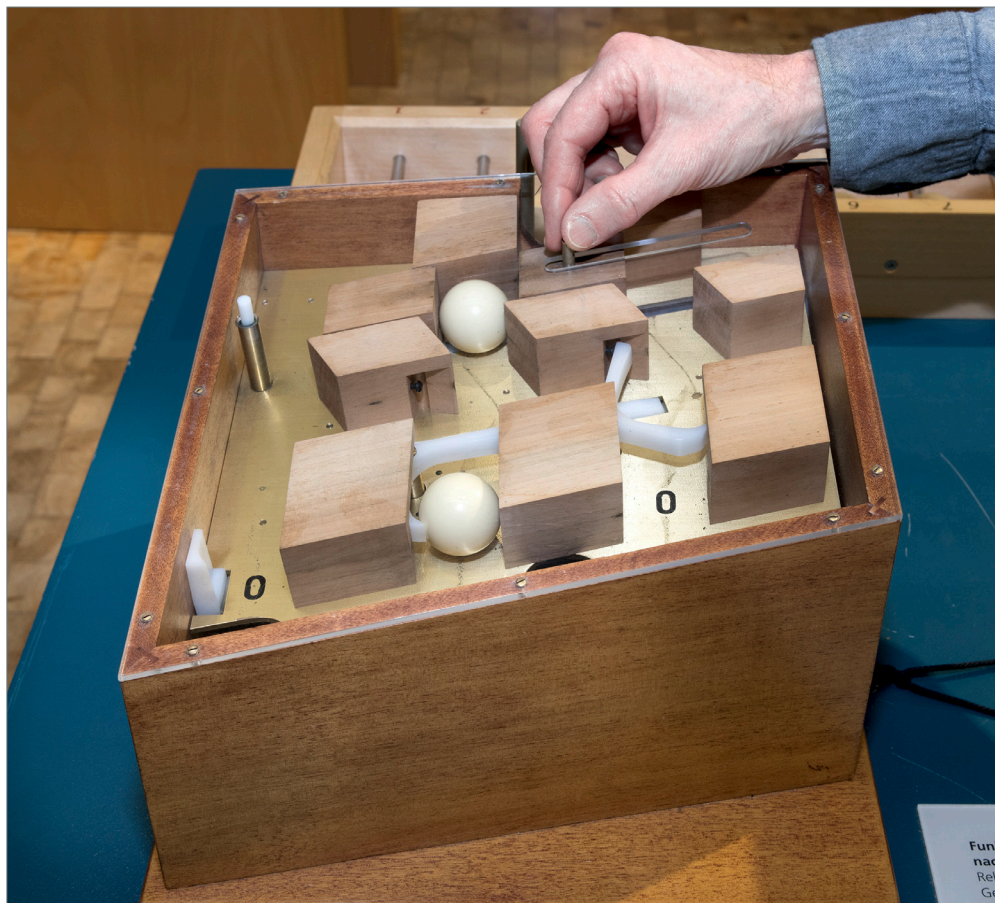
Abb. 8: Funktionsmodell der Dual-Rechen- maschine nach Leibniz, rekonstruiert von Ludolf von Mackensen, gebaut von Gerhard Weber, EVZ: 2007/0405 TECHNOSEUM, Foto: Klaus Luginsland
