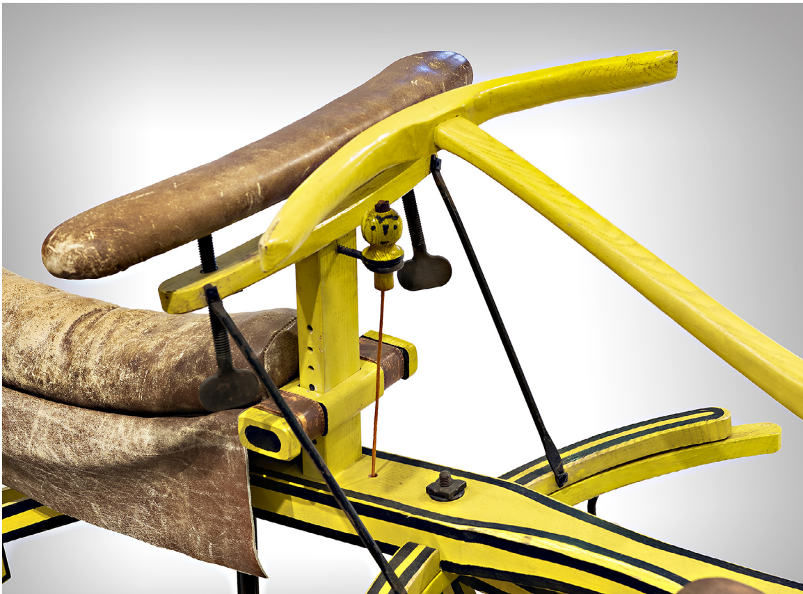
Abb. 3: Lenkung mit „Balancierbrett“ der Drais’schen Laufmaschine TECHNOSEUM, Foto: Klaus Luginsland
