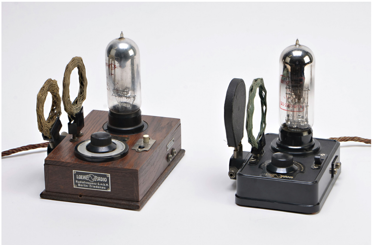
Abb. 4: OE 333 mit Holz- und Kunststoff- gehäuse, 1926-1930 TECHNOSEUM, Foto: Markus Klejnowski
