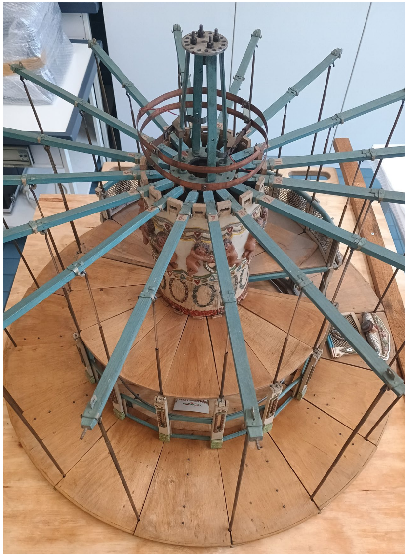
Abb. 8 Drehbare Konstruktion mit Auslegern und Hängestangen Foto: Emelie Kories
