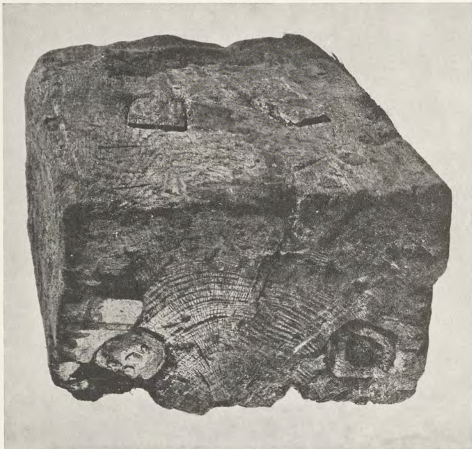
Abb. 159. Pumpenstock aus Eichenholz von einer Saug- und Druckpumpe; gefunden in Oberkirch
