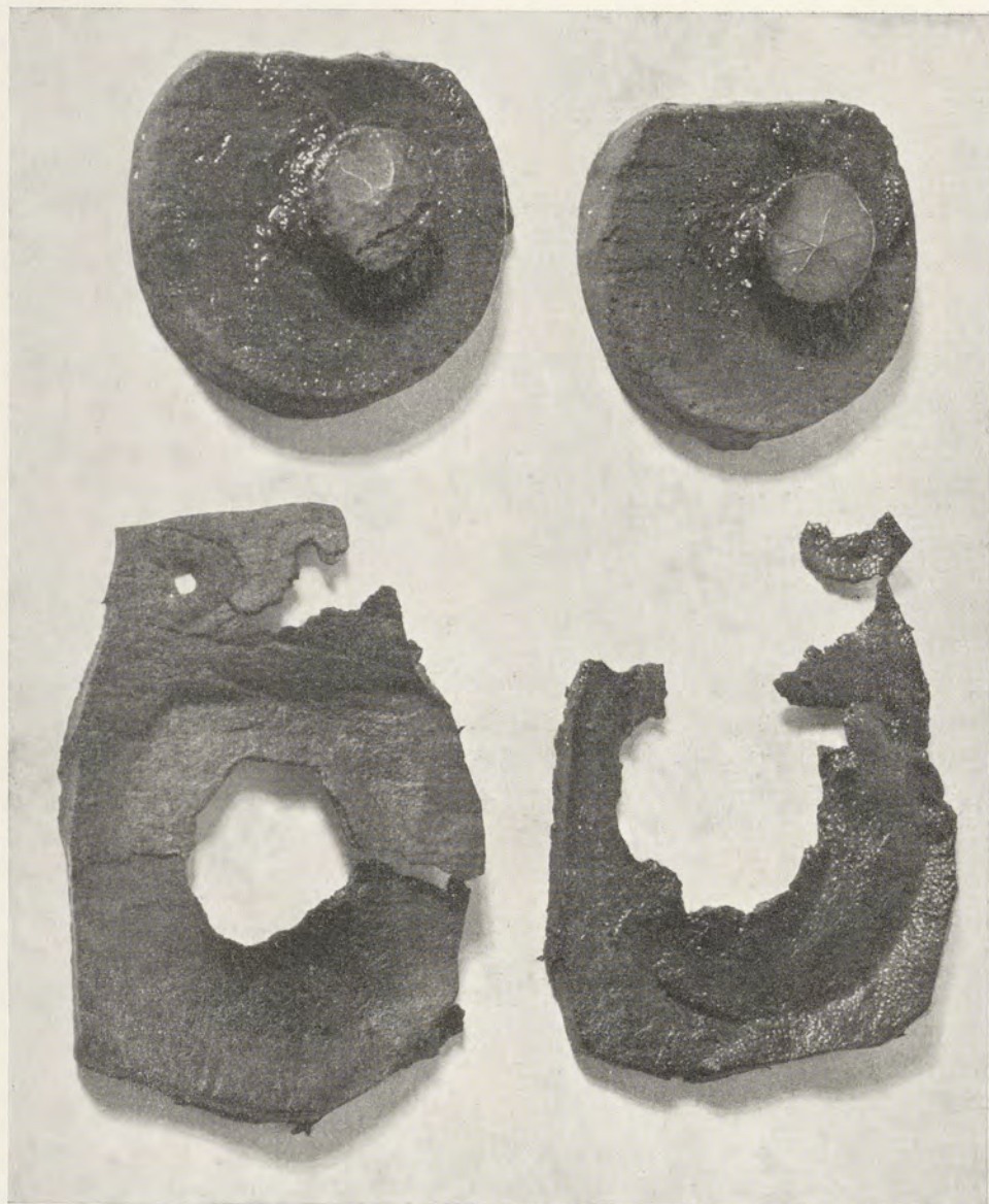
Abb. 161. Klappventile aus Leder mit Bleibolzen von einer Saug- und Druckpumpe aus Oberkirch
